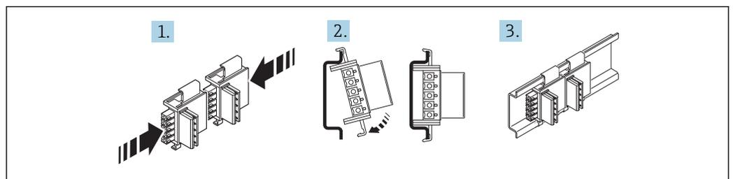
**2** Montaje del conector de bus de raíl DIN 17,5 mm (0,69 in)
