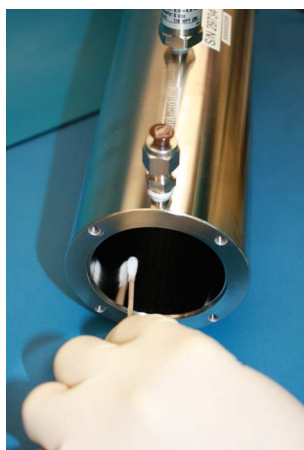
Rys. B-8 Usuwanie nadmiaru taśmy uszczelniającej z wnętrza celi
