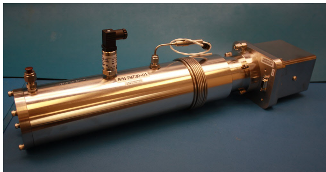
Rys. B-11 Czujnik ciśnienia po zamontowaniu
