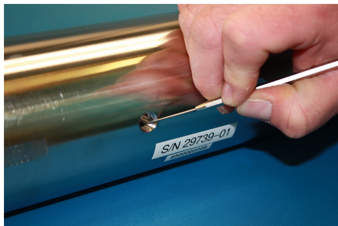
Rys. B-7 Usuwanie nadmiaru taśmy uszczelniającej z kołnierza
