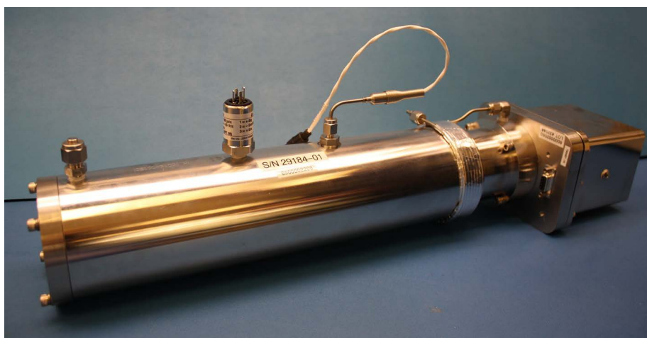
Rys. B-5 Wymontowana cela pomiarowa 28 m
