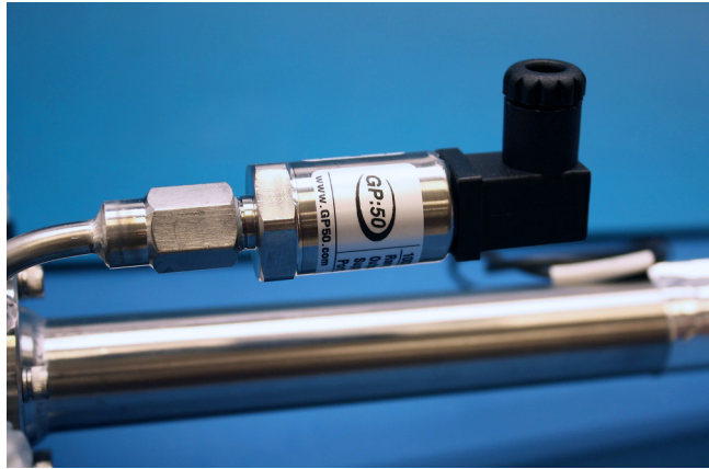
Rys. B-17 Ustawienie czujnika ciśnienia bezpośrednio po zamontowaniu
