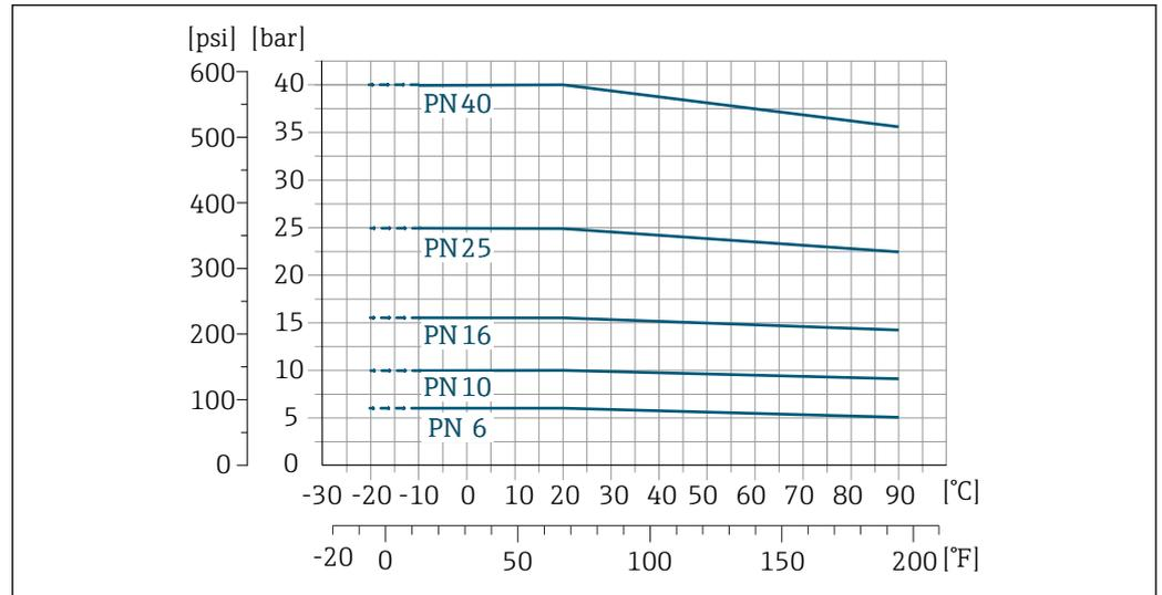
15 Werkstoff Prozessanschluss: Rostfreier Stahl (-20 °C (-4 °F)); Kohlenstoffstahl (-10 °C (14 °F))
