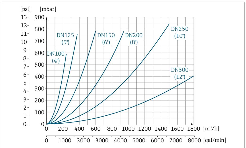
24 Druckverlust DN 100 ... 300 (4 ... 12") bei Bestellmerkmal "Bauart", Option C "Festflansch, Messrohr eingeschnürt, 0 x DN Ein-/Auslaufstrecken"
