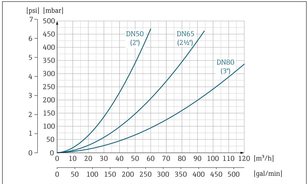
23 Druckverlust DN 50 ... 80 (2 ... 3") bei Bestellmerkmal "Bauart", Option C "Festflansch, Messrohr eingeschnürt, 0 x DN Ein-/Auslaufstrecken"
