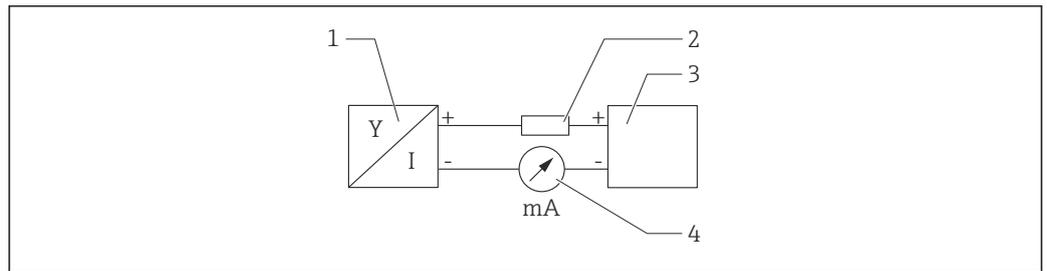
16 Diagrama de bloques de la conexión HART
