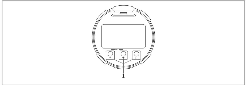
Fig. 22 Indicador gráfico con teclas de configuración ópticas (1)
