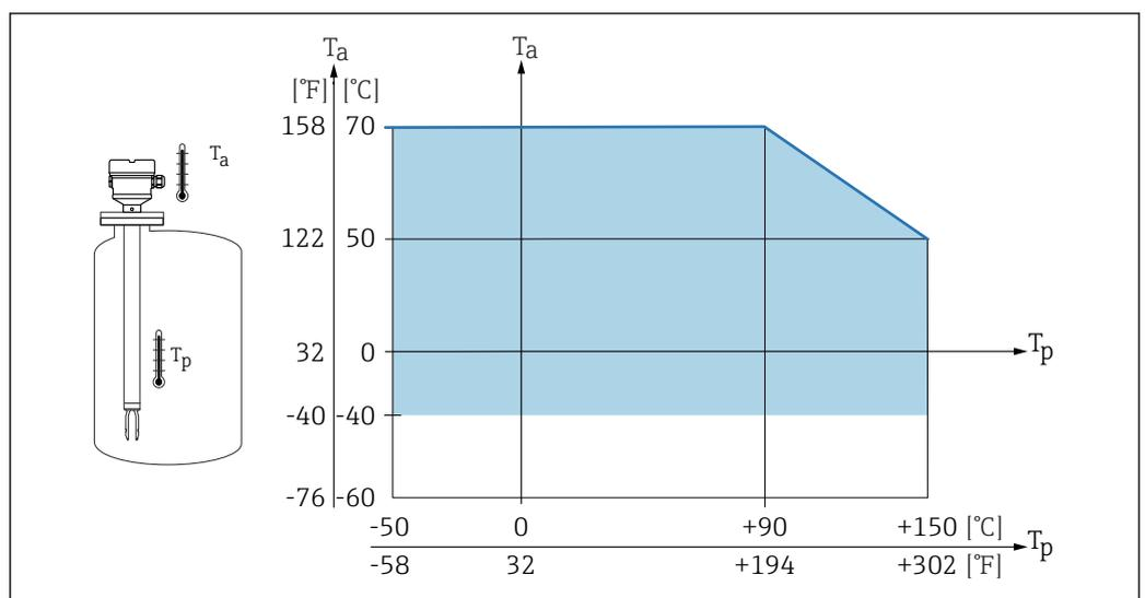
34 Temperatura ambiente admisible  $T_a$  en la caja en función de la temperatura de proceso  $T_p$  en el depósito
