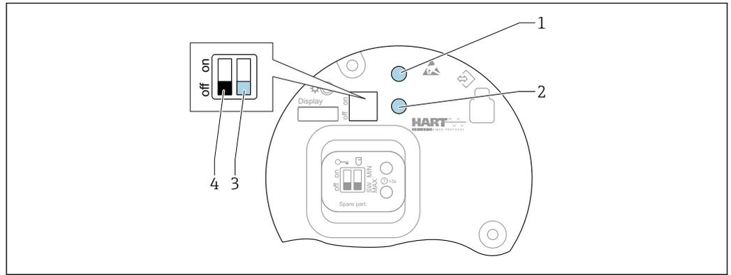
24 Teclas de configuración y microinterruptores en el módulo de la electrónica 4 ... 20 mA HART del equipo
