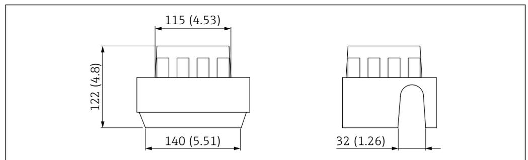
28 Cubierta de protección para la caja de compartimento único, aluminio o 316L. Unidad de medida mm (in)
