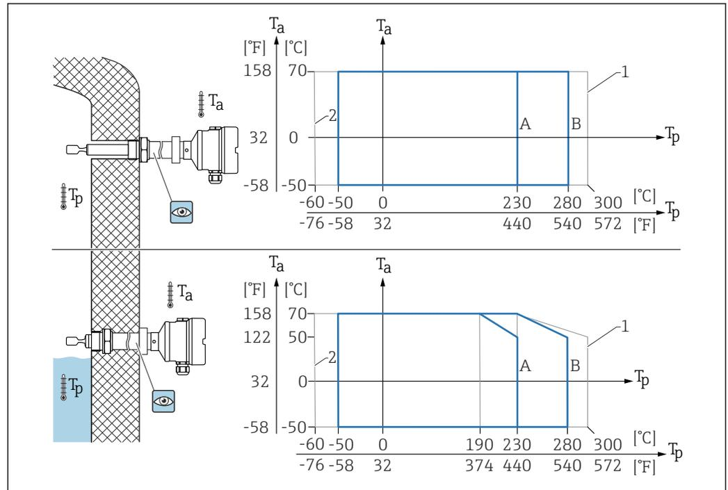
34 Temperatura ambiente admisible  $T_a$  en la caja en función de la temperatura de proceso  $T_p$  en el depósito
