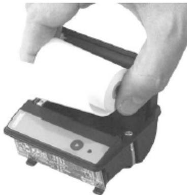
Insérer le nouveau rouleau de papier dans le compartiment à papier, en veillant à ce que l'extérieur soit orienté vers le mécanisme de l'imprimante. C'est le seul côté imprimable.
