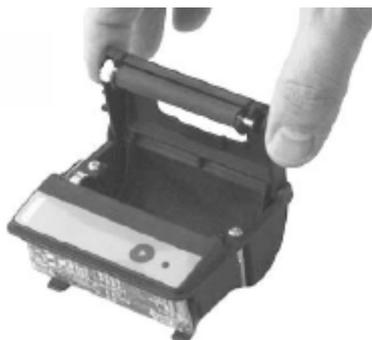
Pousser légèrement vers le haut le levier situé à l'intérieur du couvercle. Le rouleau d'impression est soulevé hors du mécanisme de l'imprimante en même temps que le couvercle.
