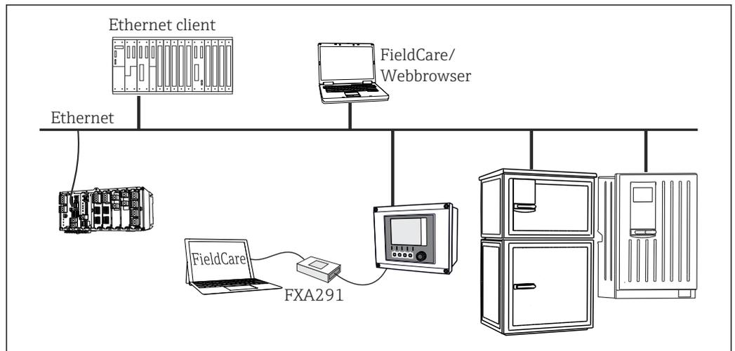
23 Modbus TCP oder EtherNet/IP oder PROFINET
