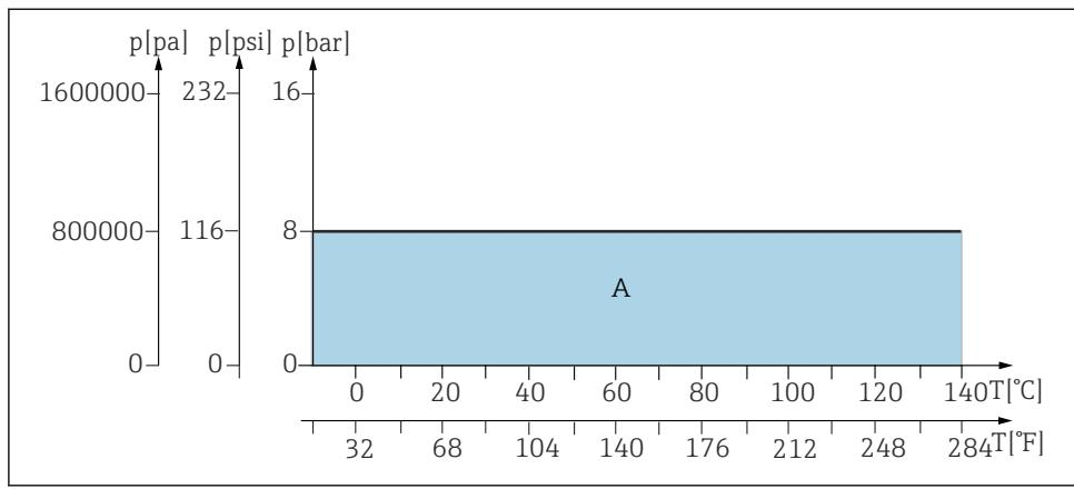
■ 52 Krivulje tlak-temperatura za osnovno izvedbo in izvedbo s potopno komoro, za material 1.4404, zlitino C22 in PEEK
