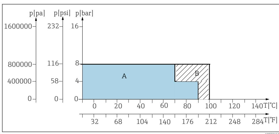
■ 53 Krivulje tlak-temperatura za osnovno izvedbo, za material PVDF in prevoden PVDF
