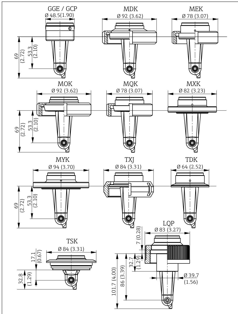
图 16 过程连接示意图；单位：mm (inch)
