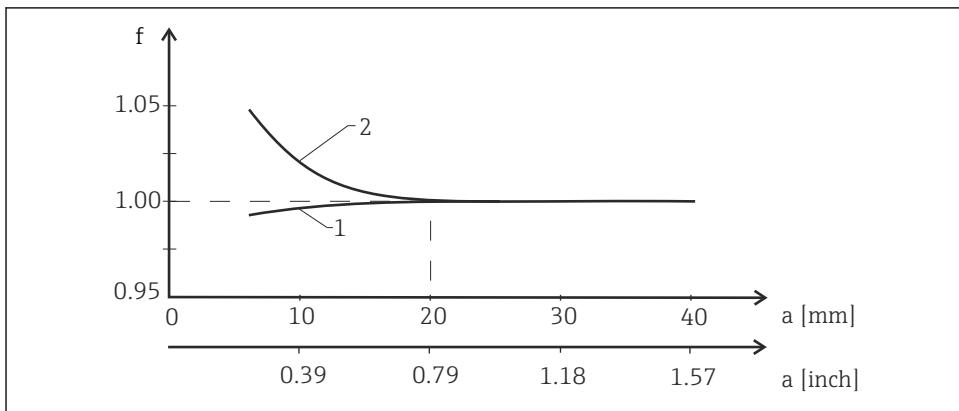
图 4 安装系数 (f) 和传感器与管壁间距离 (a) 的关系
