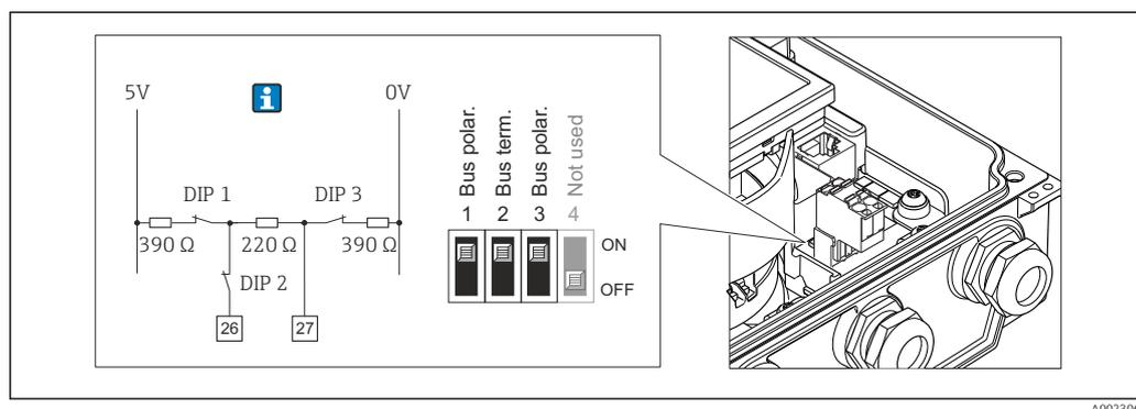
14 Нагрузочный резистор можно активировать с помощью DIP-переключателя на модуле электроники
