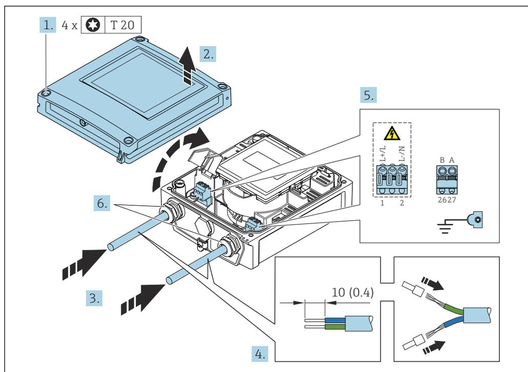
12 Подключение сетевого напряжения и Modbus RS485
