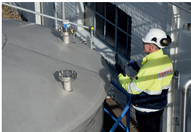
Industrietablet Field Xpert SMT70 für die Verwaltung der Konfiguration mobiler Geräte.
