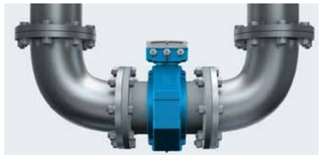
Proline Promag Geräte können direkt nach Rohrbögen installiert werden
