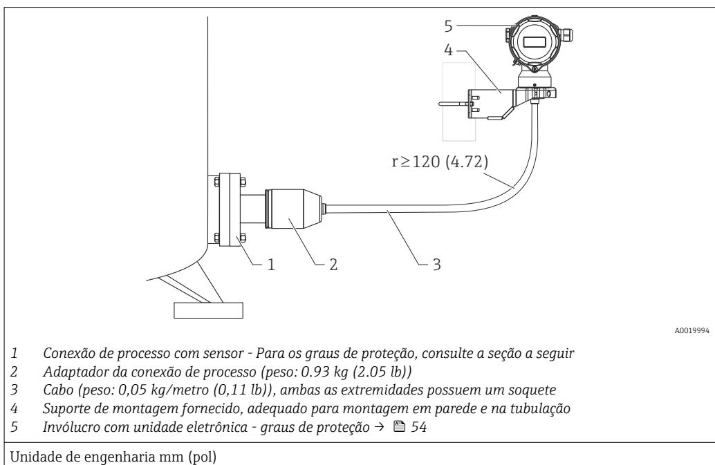
Grau de proteção para a conexão de processo e para o sensor com o uso de
