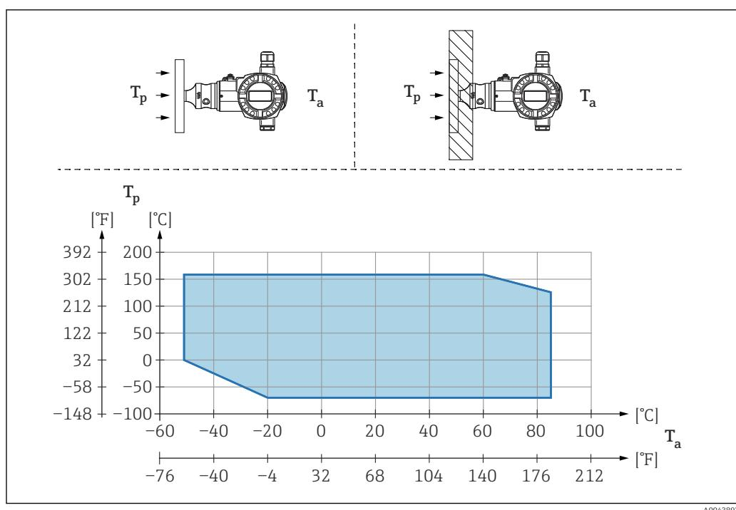
$T_a$  Temperatura ambiente no transmissor $T_p$  Temperatura máxima do processo
