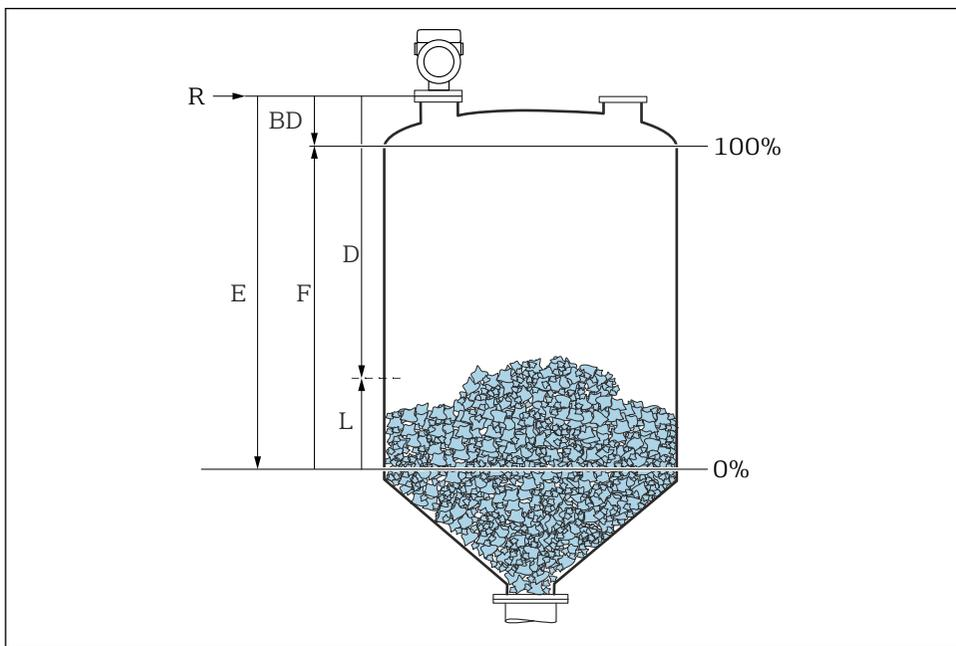
▣ 26 Параметры конфигурации для измерения уровня жидкости
