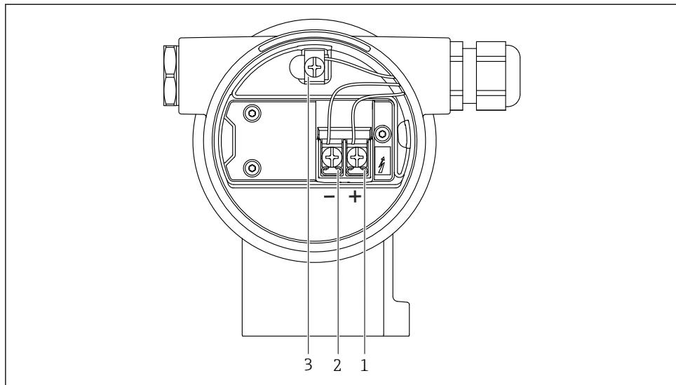
図 4 端子部の接続端子と接地端子
