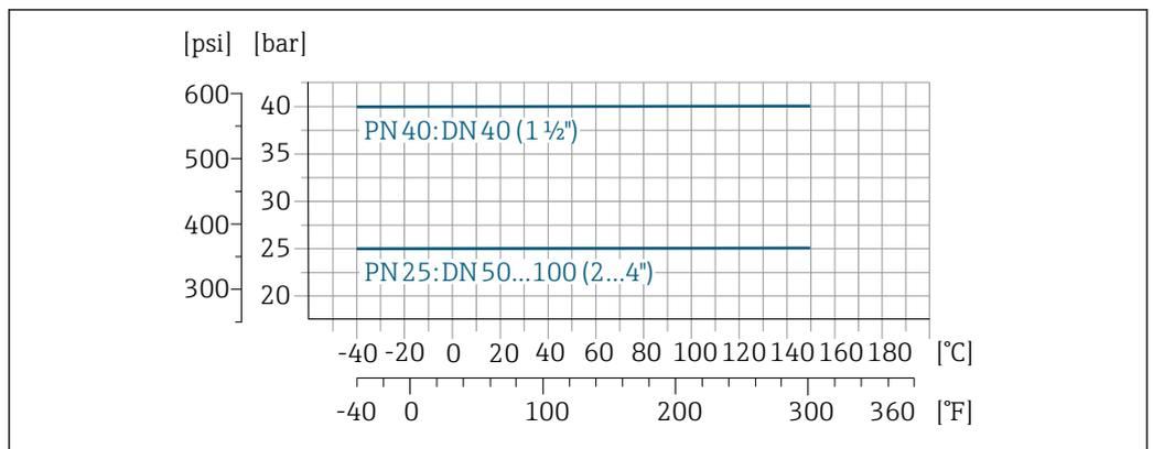
48 Materiale della connessione al processo: acciaio inox, 1.4404 (F316L)
