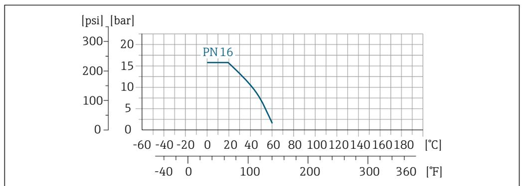
38 Materiale della connessione al processo: PVC-U
