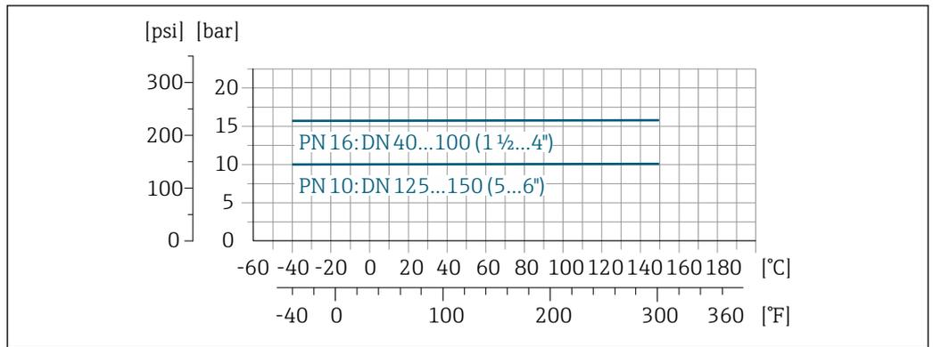
47 Materiale della connessione al processo: acciaio inox, 1.4404 (F316L)
