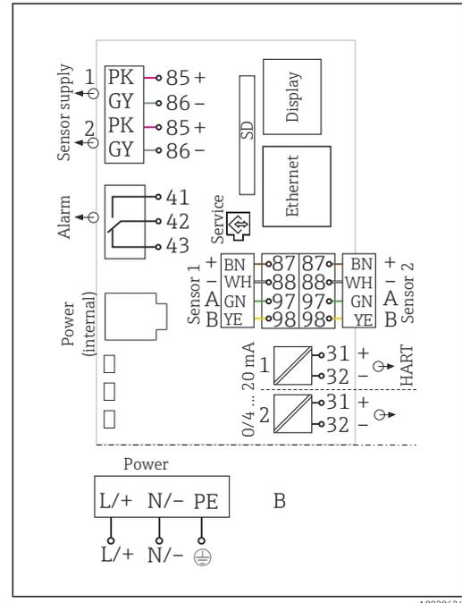
15 Collegamento dell'alimentazione utilizzando l'esempio di BASE2-E
