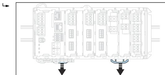
2. Installare il dispositivo sulla guida DIN (a) appoggiandolo su di essa, quindi premere per fissarlo (b).
