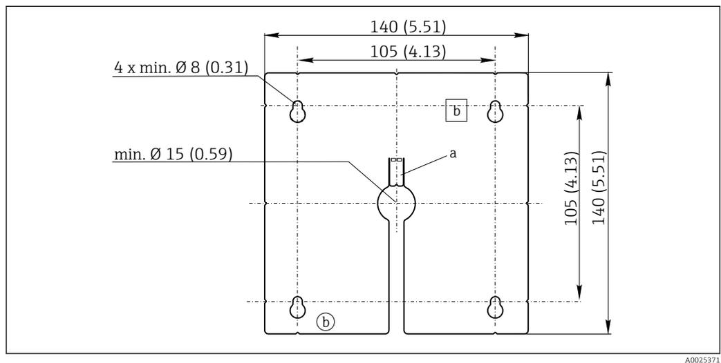
10 Piastra di montaggio del display separato, dimensioni in mm (in)
