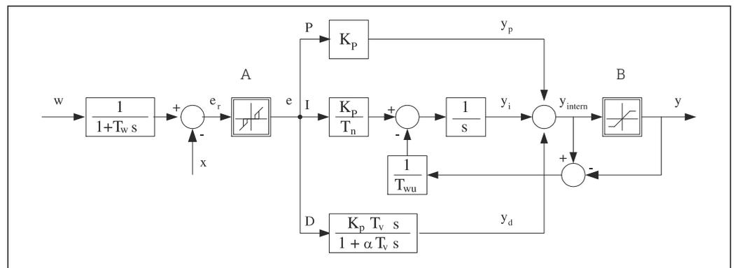
59 Diagramma a blocchi della struttura del controllore
