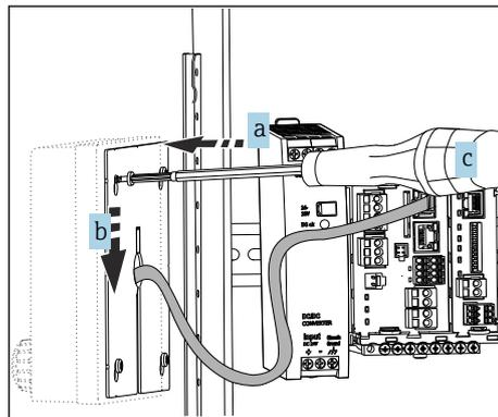
7. Posizionare la piastra di montaggio (a) dall'interno sopra le viti, farla scorrere verso il basso (b) e serrare le viti (c).
