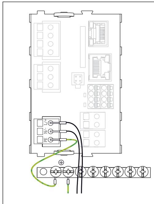
13 Collegamento dell'alimentazione utilizzando l'esempio di BASE2-H o -L
