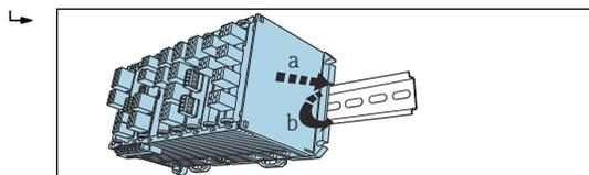
3. Fare scorrere le clip di fissaggio verso l'alto fino allo scatto, fissando in questo modo il dispositivo alla guida DIN.
