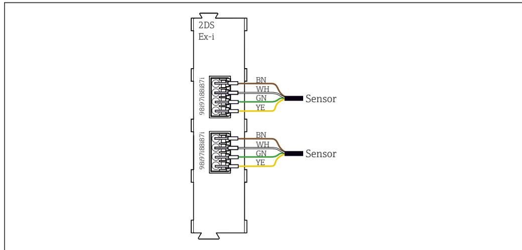
21 Sensori senza tensione di alimentazione aggiuntiva sul modulo di comunicazione sensori tipo 2DS Ex-i
