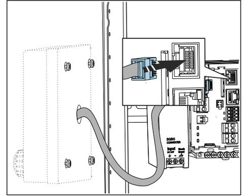
5. Tirare il cavo del display facendolo passare attraverso il foro centrale e fissare il display dall'esterno nei quattro fori praticati a questo scopo, assicurandosi che le viti Torx (a testa svasata) siano state precedentemente allentate fino all'ultimo mezzo giro, ma siano ancora in posizione. Garantire che il telaio in gomma (guarnizione, contraddistinta in blu) non venga danneggiato e sia posizionato correttamente sulla superficie della porta.
