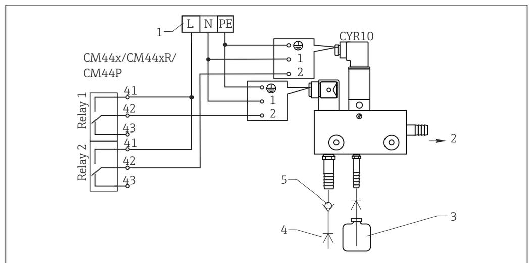
35 Connessione del sistema di pulizia con iniettore CYR10
