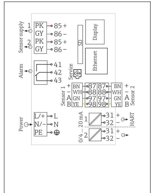
14 Schema elettrico completo utilizzando l'esempio di BASE2-H o -L
