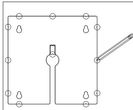
1. Afferrare la piastra di montaggio dall'esterno, tenendola contro la porta dell'armadio di controllo. Scegliere la posizione in cui si intende installare il display.
