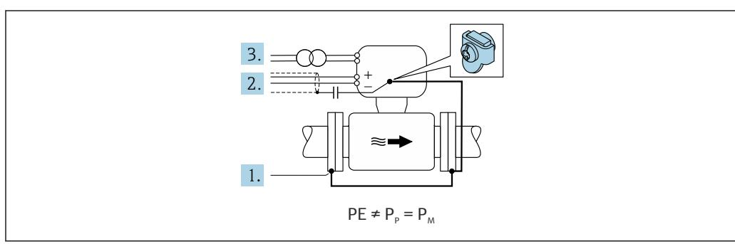
1. 接地ケーブルを介して配管法兰と変換器を接続します。
