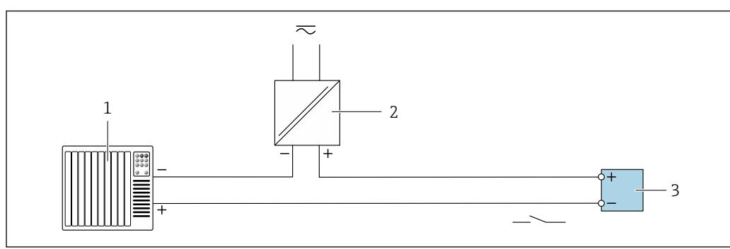
図 14 スイッチ出力（パッシブ）の接続例
