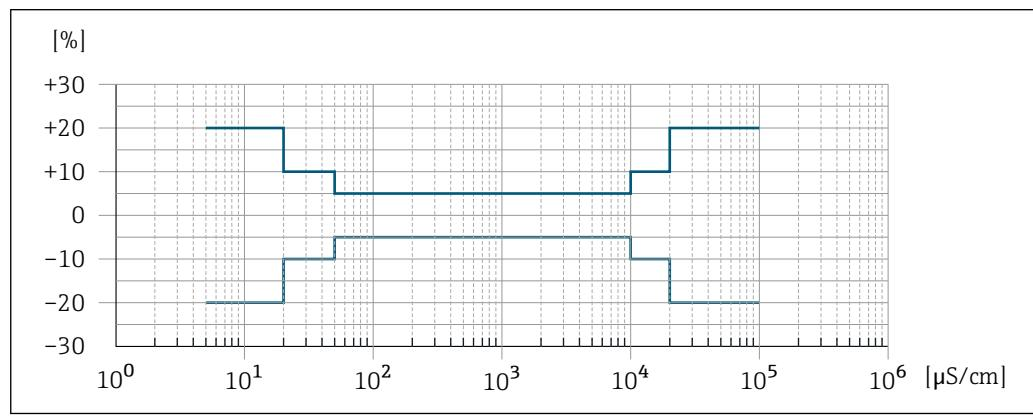
図 37 測定誤差（オプション：「校正された導電率測定」のオーダーコード、オプション CW）
