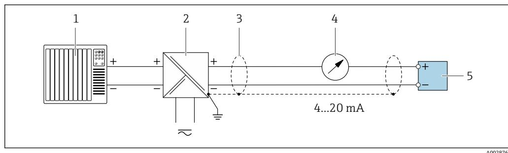
図 9 4～20 mA HART 電流出力（パッシブ）の接続例
