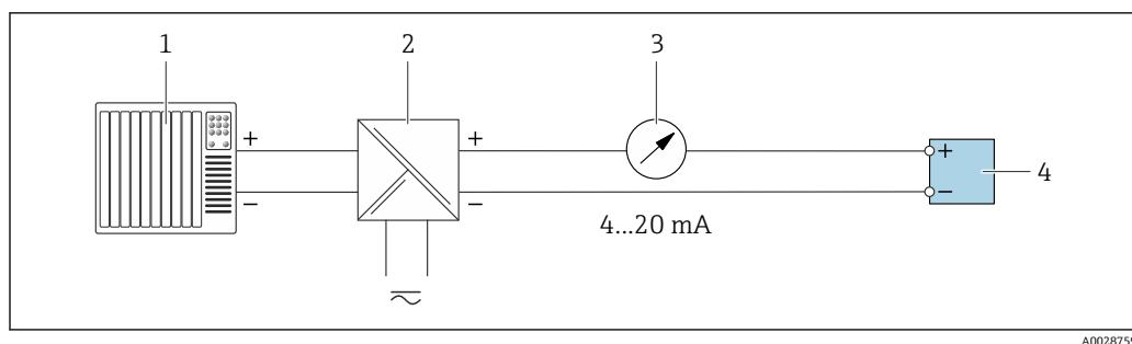
図 12 4~20 mA 電流出力（パッシブ）の接続例
