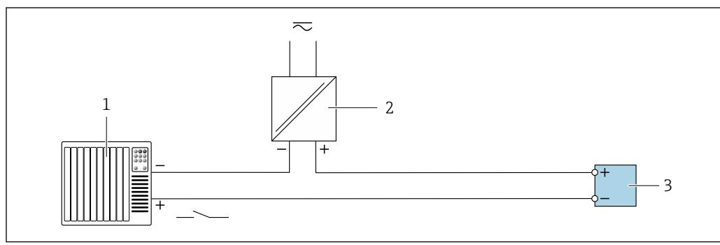
図 19 ステータス入力の接続例
