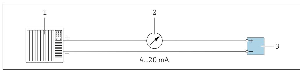
図 11 4～20 mA 電流出力（アクティブ）の接続例
