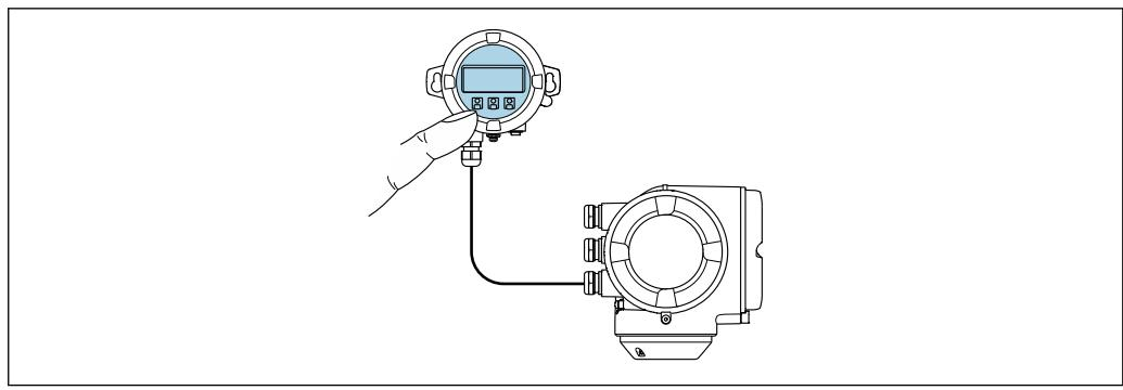
図 42 分離型ディスプレイと操作モジュール DKX001 を介した操作
