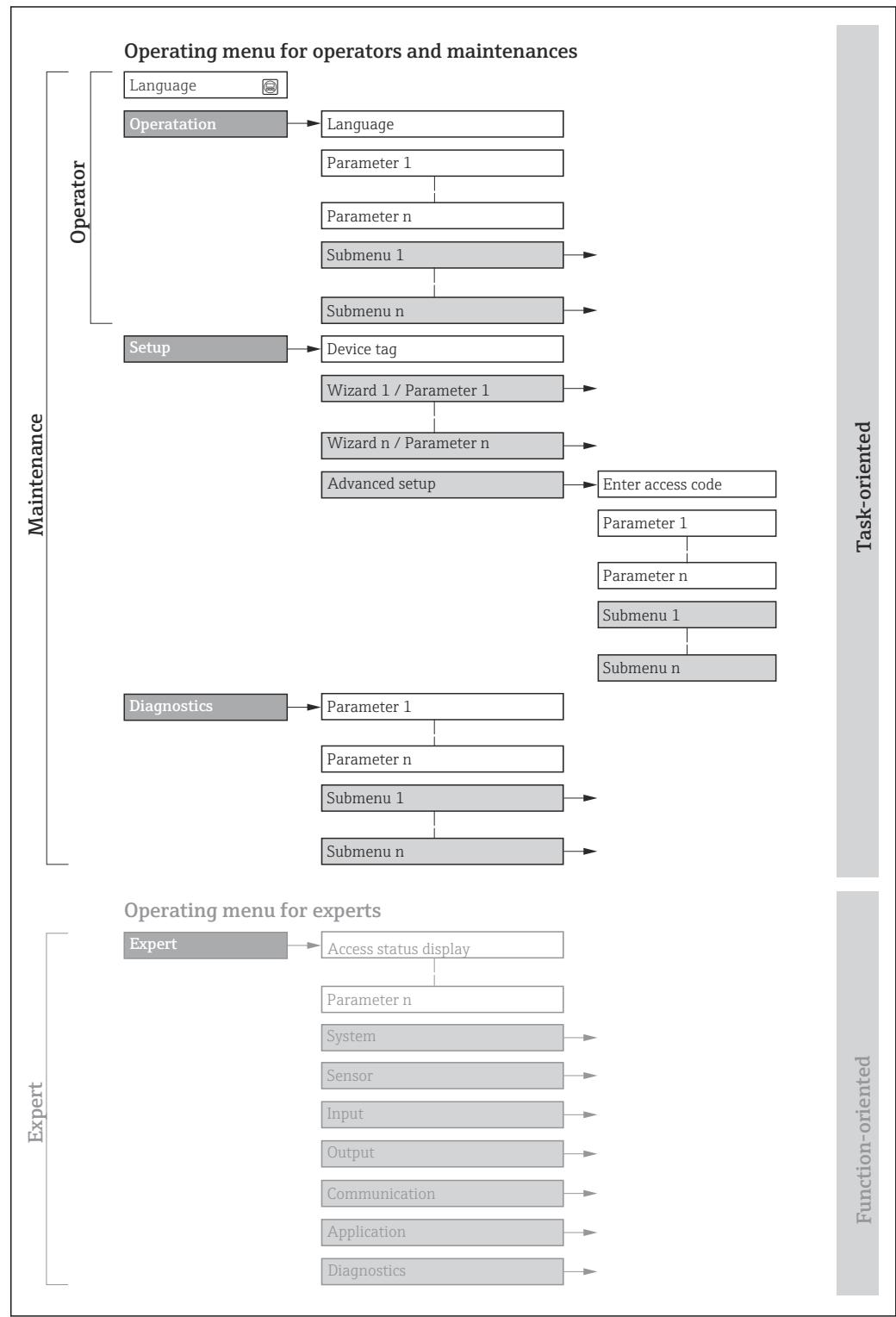
図 20 操作メニューの概要構成
