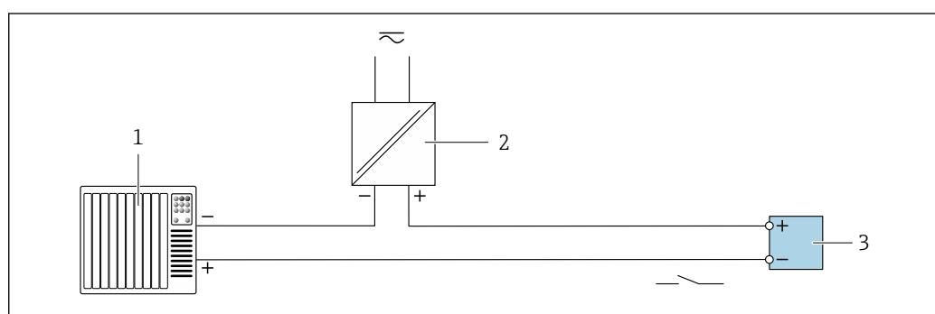
図 17 リレー出力（パッシブ）の接続例
