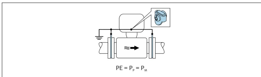
1. соедините заземляющие диски с клеммой заземления преобразователя или клеммного отсека датчика заземляющим кабелем.
