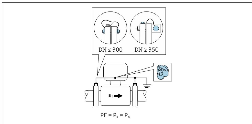
1. Соедините оба фланца датчика с фланцами трубопровода заземляющими кабелями и заземлите их.
