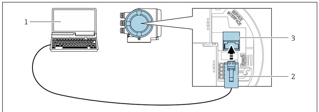
68 Conexão através de Interface de operação (CDI-RJ45)
