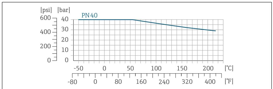
32 Flange da junta de lapela com material do flange: 1.4301 (F304), partes molhadas Liga C22: 2.4602 (UNS N06022)
