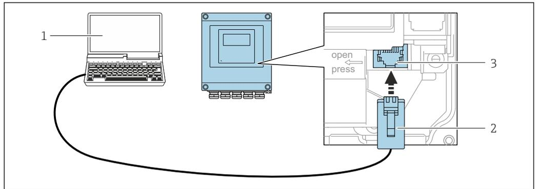
67 Conexão através de Interface de operação (CDI-RJ45)
