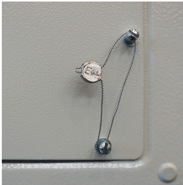
27 Schrauben mit Verplombung
