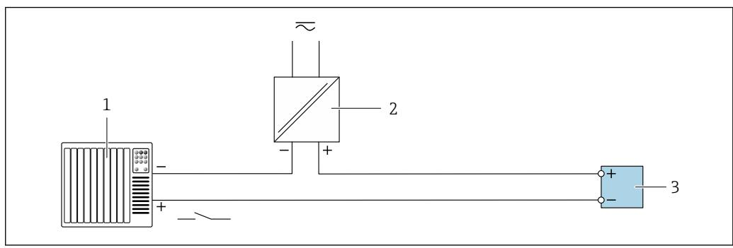
□ 24 Пример подключения для входного сигнала состояния
