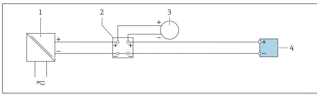
■ 23 Пример подключения для токового входа 4-20 мА
