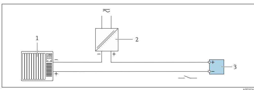
**■ 19 Пример подключения для релейного выхода (пассивного)**
