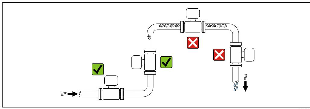
Во избежание погрешностей измерения, проявляющихся в результате скопления газовых пузырьков в измерительной трубе, следует избегать следующих мест монтажа в трубопроводе:
