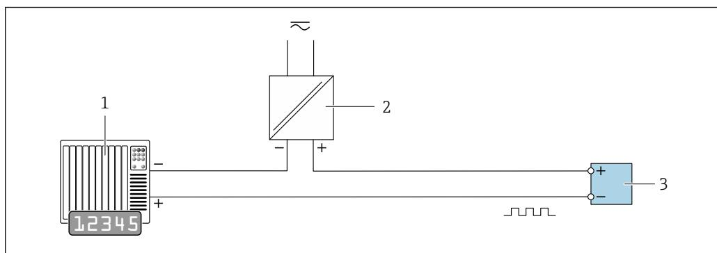
**■ 18 Пример подключения для импульсного/частотного выхода (пассивного)**
