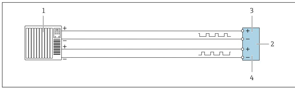
**■ 20 Пример подключения двойного импульсного выхода (активного)**
