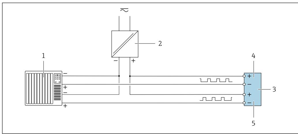
■ 21 Пример подключения двойного импульсного выхода (пассивного)
