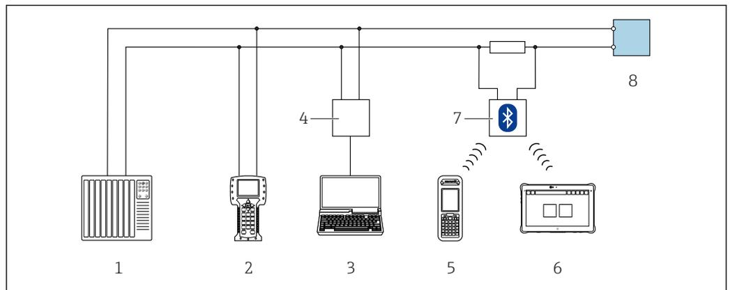
Fig. 27 Opciones para la configuración a distancia mediante el protocolo HART (activo)
