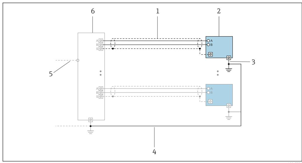
Fig 9 Exemplo de conexão para PROFINET com Ethernet-APL
