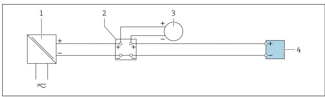
■ 20 Exemplo de conexão para entrada em corrente de 4 a 20 mA
