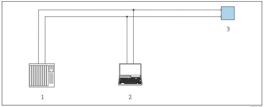
■ 61 Opções para operação remota através do protocolo Modbus-RS485 (ativa)
