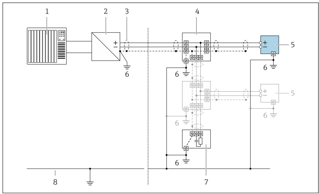
■ 11 Exemplo de conexão para o FOUNDATION Fieldbus
