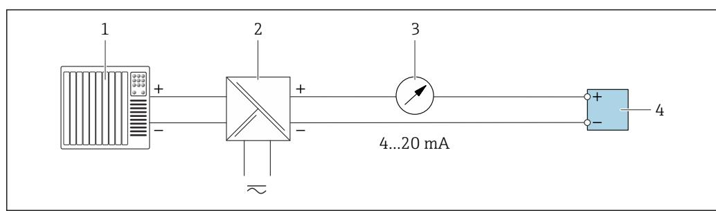
FIG 14 Exemplo de conexão para saída de corrente 4-20 mA (passiva)
