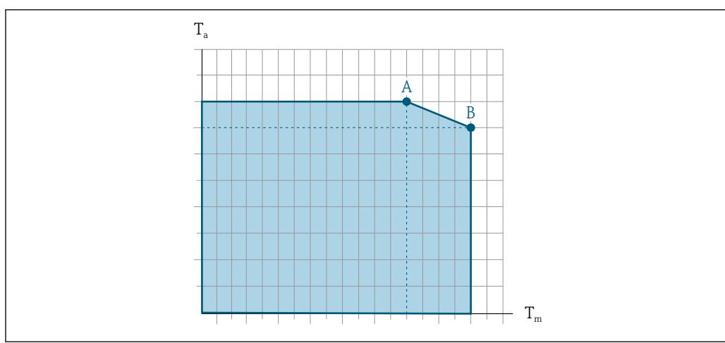
**30** Representação exemplar, valores na tabela abaixo. **$T_a$**  Temperatura ambiente **$T_m$**  Temperatura do meio**A** Temperatura máxima permitida do meio  $T_m$  a  $T_{a\max.} = 60^\circ\text{C}$  ( $140^\circ\text{F}$ ); temperaturas do meio mais altas  $T_m$  requerem uma redução na temperatura ambiente  $T_a$ **B** Temperatura ambiente  $T_a$  máxima permitida para a temperatura média  $T_m$  máxima especificada do sensor
