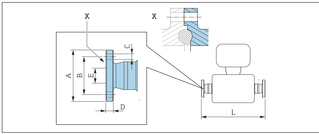
■ 39 Detalhe X: Conexão de processo assimétrica; a peça exibida em azul é fornecida pelo fornecedor.
