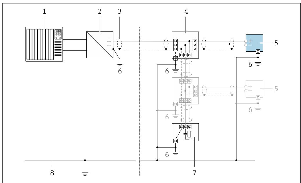
Fig. 5 Exemplo de conexão elétrica para PROFIBUS PA
