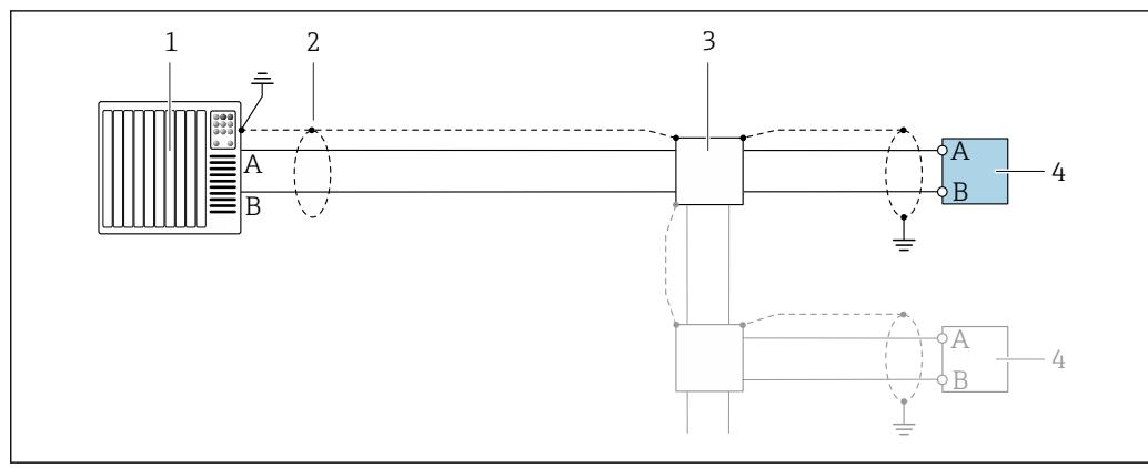
FIG 12 Exemplo de conexão para Modbus RS485, área não classificada e Zona 2; Classe I, Divisão 2
