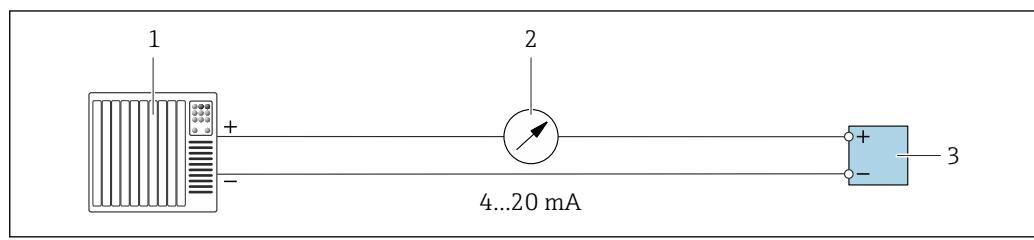
FIG 13 Exemplo de conexão para saída de corrente 4-20 mA (ativa)
