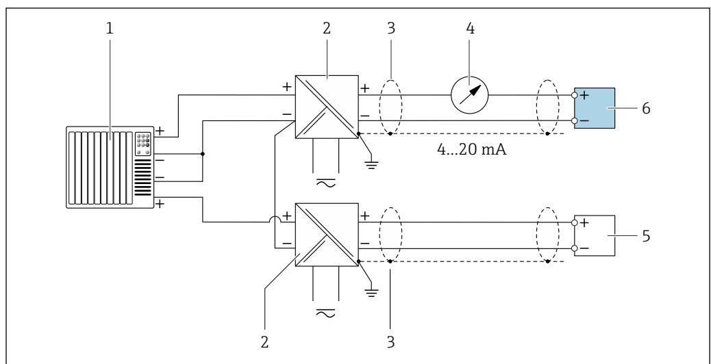
Fig. 4 Exemplo de conexão entrada HART com um ponto comum negativo (passivo)
