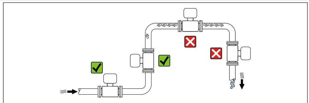
Pour éviter les écarts de mesure dues à l'accumulation de bulles de gaz dans le tube de mesure, éviter les emplacements de montage suivants dans la conduite :
