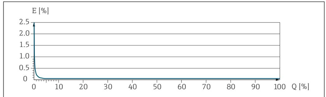
E Erreur de mesure maximale en % de m. (exemple avec PremiumCal)
