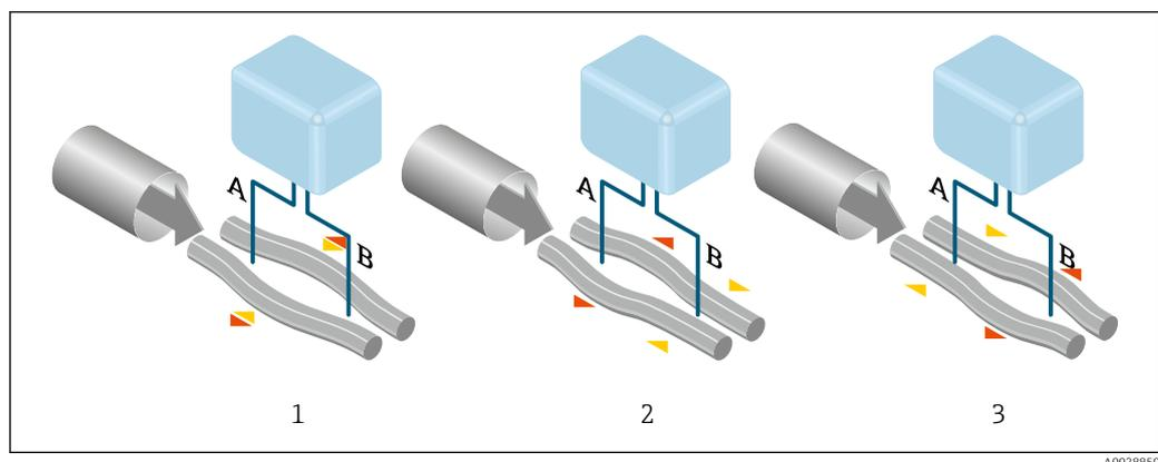
Le déphasage (A - B) est directement proportionnel au débit massique. Les oscillations des tubes de mesure sont captées par des capteurs électrodynamiques à l'entrée et à la sortie. L'équilibre du système est obtenu par une oscillation en opposition de phase des deux tubes de mesure. Le principe de mesure fonctionne indépendamment de la température, de la pression, de la viscosité, de la conductivité et du profil d'écoulement.
