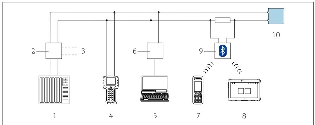
50 Opções para operação remota através do protocolo HART (passiva)
