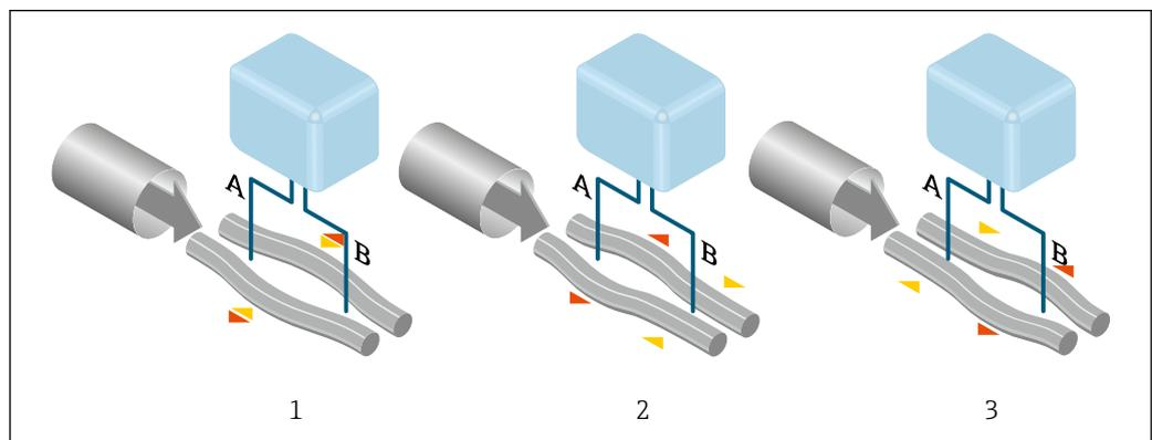
A diferença de fase (A-B) aumenta com o aumento da vazão mássica. Os sensores eletrodinâmicos registram as oscilações do tubo na entrada e na saída. O equilíbrio do sistema é garantido pela oscilação da antifase dos dois tubos de medição. O princípio de medição opera independentemente da temperatura, da pressão, da viscosidade, da condutividade e do perfil de vazão.
