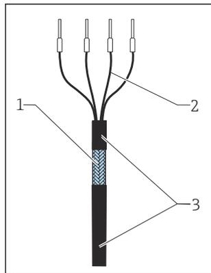
24 Konfektioniertes Kabel
