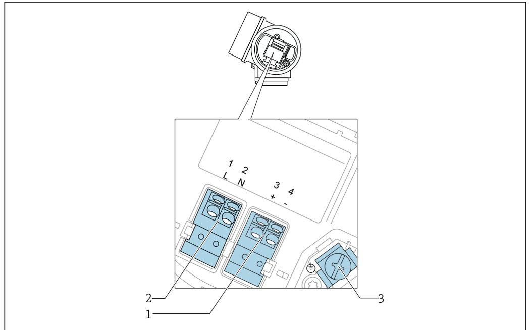
**7** Asignación de terminales a cuatro hilos: 4-20 mA HART (90 ... 253 V<sub>AC</sub>)
