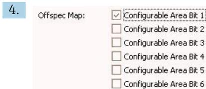
Ir a la columna **Offspec Map** y activar la casilla de verificación del bit correspondiente (en el ejemplo: **Bit de área configurable 1**). Confirme la selección pulsando la tecla Enter.
