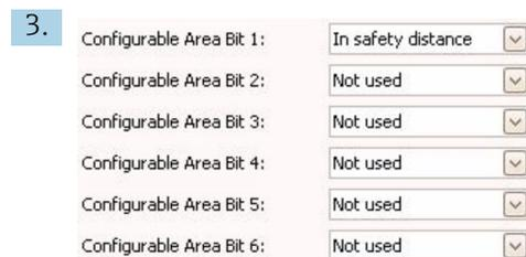
Seleccionar uno de estos bits (en el ejemplo: Bit de área configurable 1) y seleccionar **En distancia de seguridad** en el menú desplegable asociado. Confirme la selección pulsando la tecla Enter.
