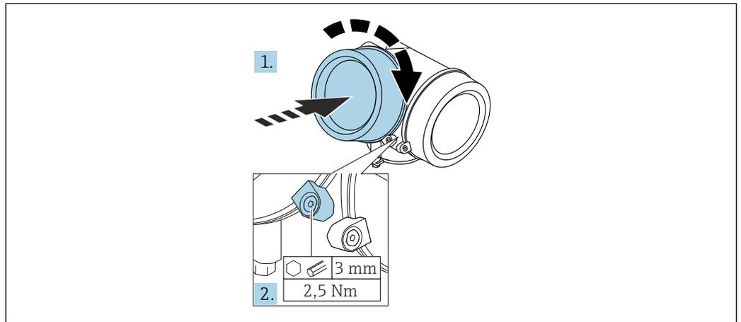
1. Vuelva a atornillar firmemente la tapa del compartimento de la electrónica.
