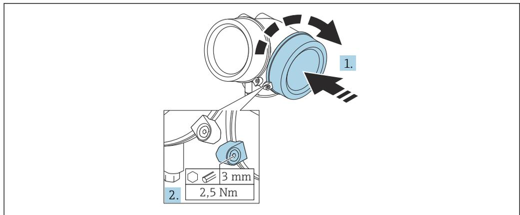
1. Vuelva a atornillar firmemente la tapa del compartimento de la conexión.
