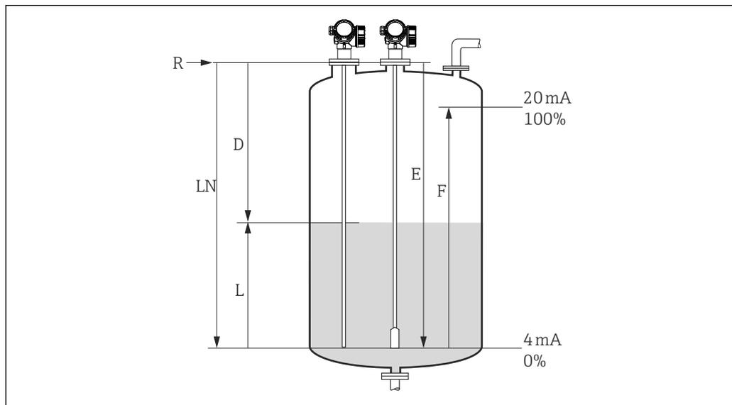
**24** Parámetros de configuración para la medición de nivel en líquidos
