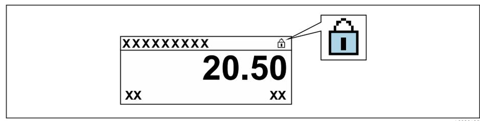
2. Al ajustar el microinterruptor WP del módulo de la electrónica principal en la posición **OFF** (ajuste de fábrica), se desactiva la protección contra escritura.
