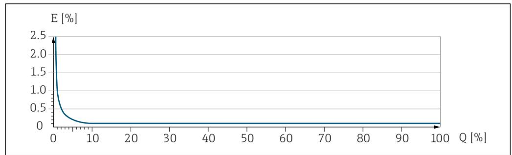
*E* Écart de mesure max. en % de *m*. (exemple)
