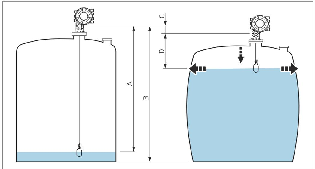
66 Correzione della deformazione idrostatica nei serbatoi ((HyTD)
