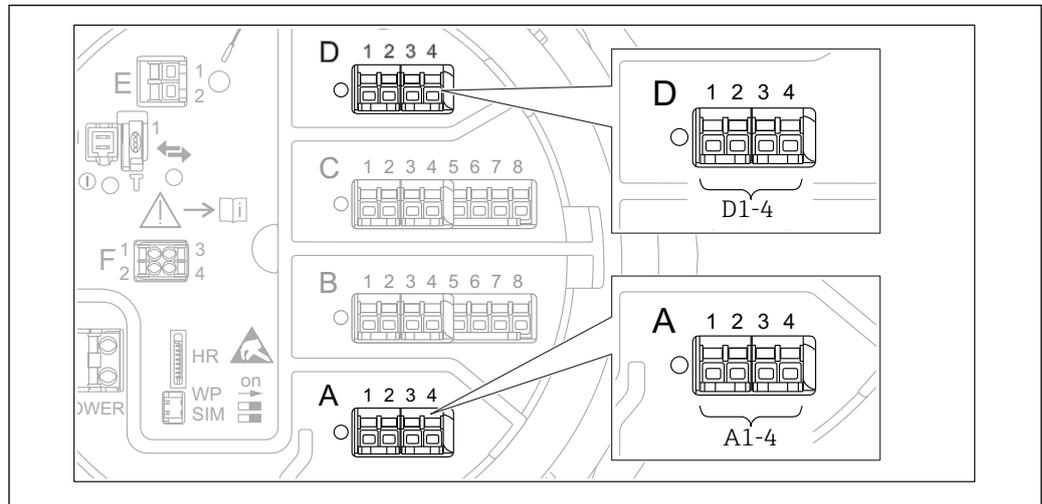
**71** Possibili posizioni dei moduli Modbus (esempi); in base alla versione del dispositivo, questi moduli possono trovarsi anche negli slot B o C → **47**.
