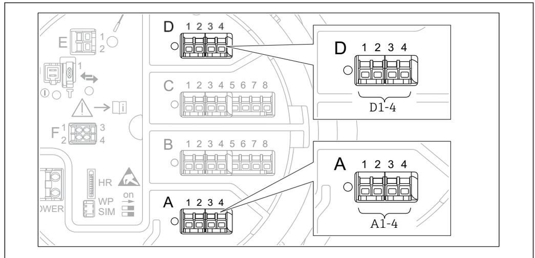
21 Designazione dei moduli "Modbus", "V1" o "WM550" (esempi); in base alla versione del dispositivo, questi moduli possono trovarsi anche negli slot B o C.
