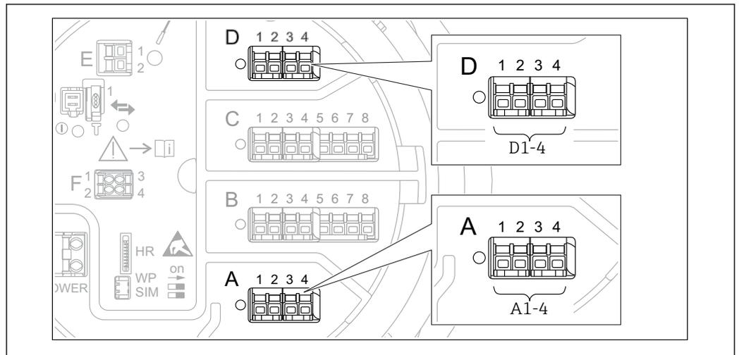
72 Possibili posizioni dei moduli V1 (esempi); in base alla versione del dispositivo, questi moduli possono trovarsi anche negli slot B o C → 47.
