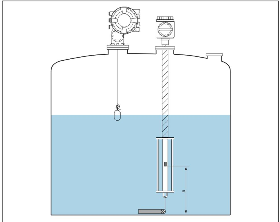
59 Prothermo NMT53x: posizione del termoelemento di fondo
