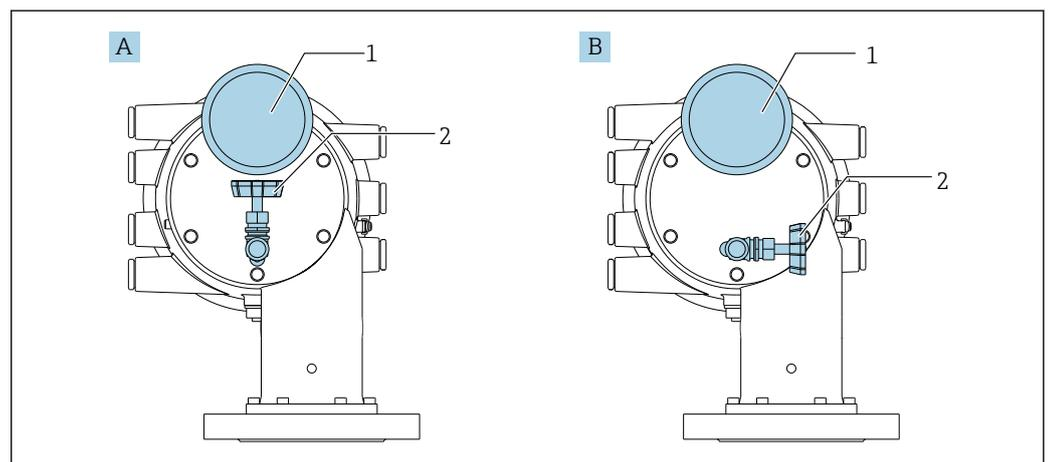
79 Posizione di montaggio della valvola di sovrappressione e del manometro
