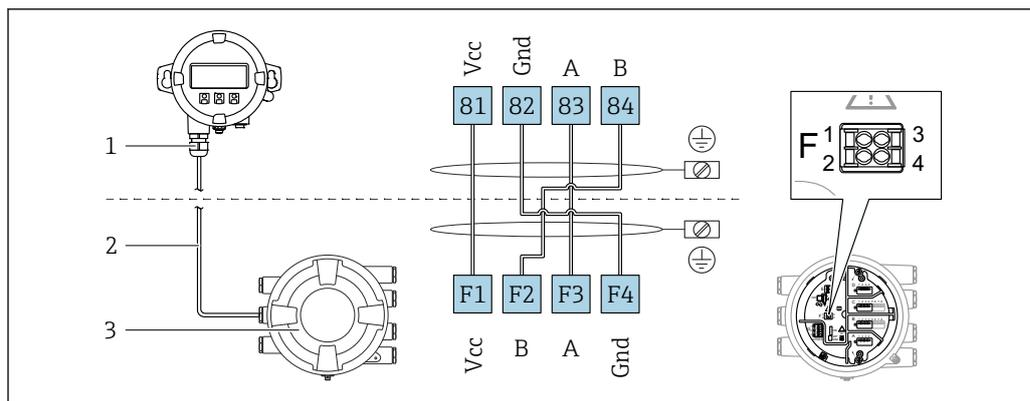
20 Connessione del modulo operativo e di visualizzazione separato DKX001 al dispositivo per la misura nei serbatoi (NMR8x, NMS8x o NRF8x)
