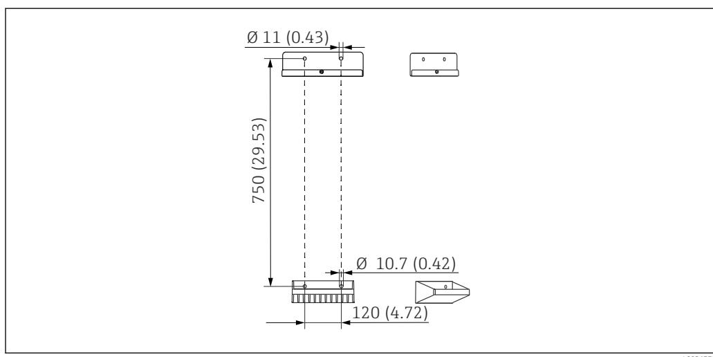
■ 18 Размеры блока держателя. Единица измерения – мм (дюйм)
