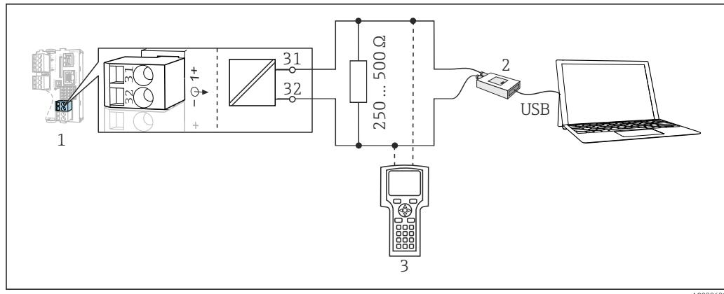
■ 24 Передача данных по протоколу HART посредством модема
