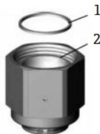
Fig 71. Centraggio della guarnizione sulla superficie di tenuta della cuffia
