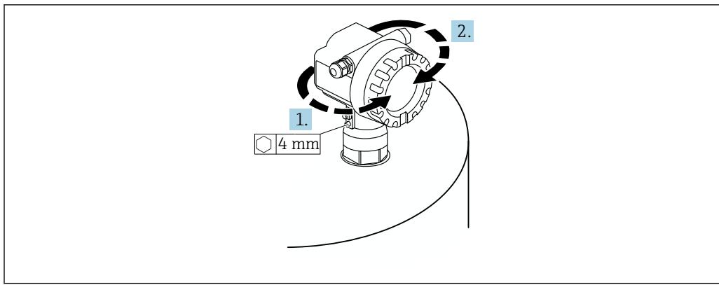
■ 10 Поворот корпуса F12 или T12, (для примера изображен корпус F12)
