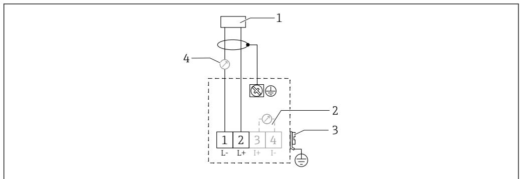
■ 13 Назначение клемм для прибора в двухпроводном исполнении
