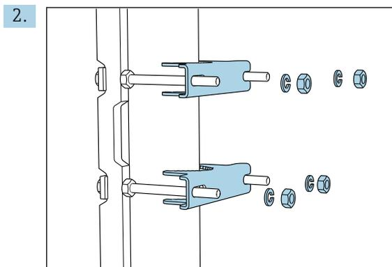
Montare i contropiezi e fissare il fermo della palina usando rondelle elastiche e dadi.
