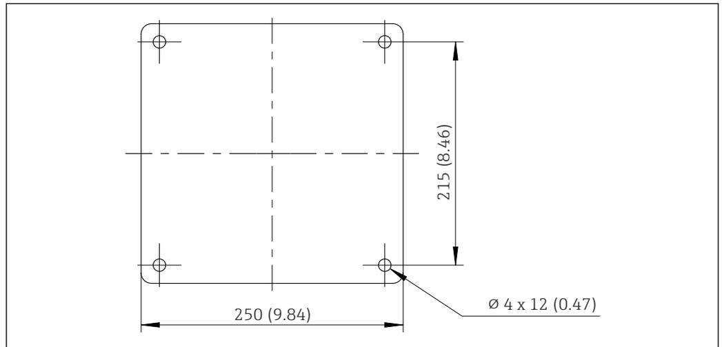
Fig. 22 Piano di fondazione, dimensioni in mm (in)
