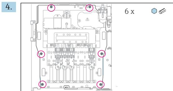
Svitare le 6 viti della scheda porta moduli mediante una chiave a brugola.
