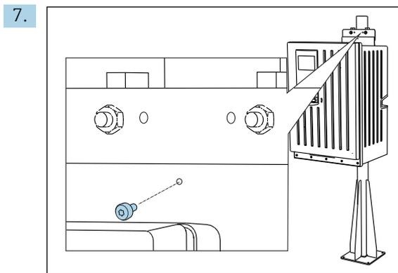
Fissare in posizione il supporto a parete superiore con la vite in dotazione.
