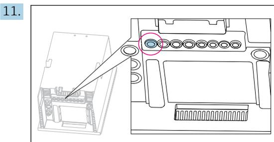
Guidare il cavo di alimentazione, fornito dal cliente sul luogo di installazione, attraverso il pressacavo indicato.
