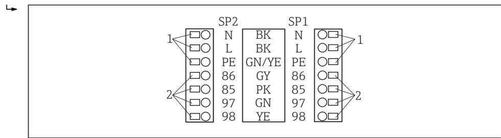
31 Schema di connessione per Liquiline System CAT820 / 860
