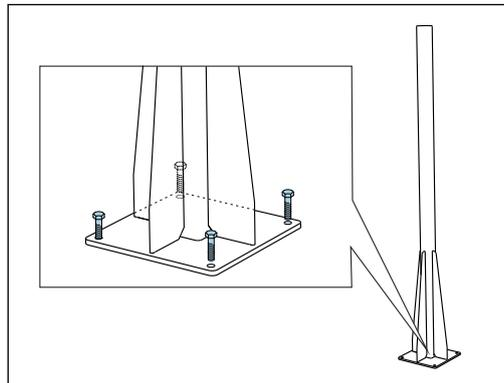
Installare la palina e montarla saldamente sulla base di ancoraggio con 4 viti di fissaggio (fornite dal cliente <sup>1)</sup>).
