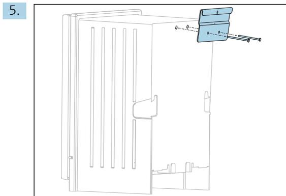
Avvitare la staffa di sospensione del supporto a parete (inclusa nella fornitura) sull'analizzatore.
