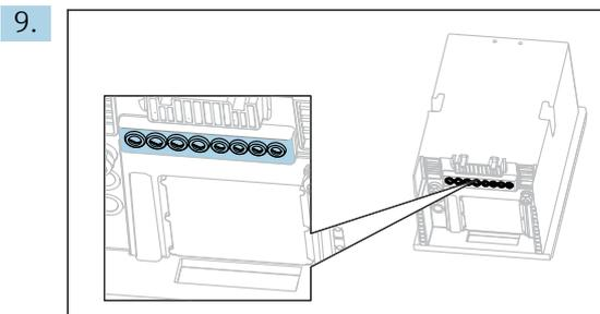
Guidare i cavi attraverso i pressacavi sul fondo del dispositivo.
