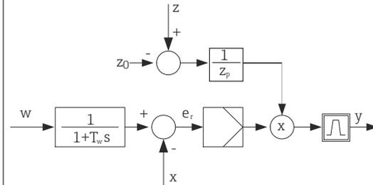
In breve, il controllo feedforward coinvolge un sistema di controllo a circuito aperto, poiché il suo effetto non è misurato direttamente. Significa che il flusso di alimentazione (feed) è diretto esclusivamente in avanti (forward). Da qui la definizione di controllo "feedforward" (controllo remoto).
