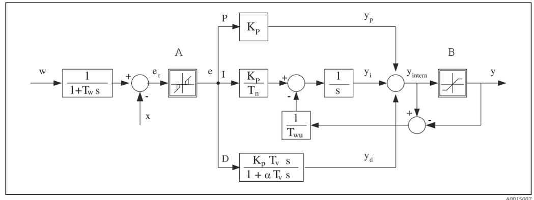
Fig. 77 Diagramma a blocchi della struttura del controllore
