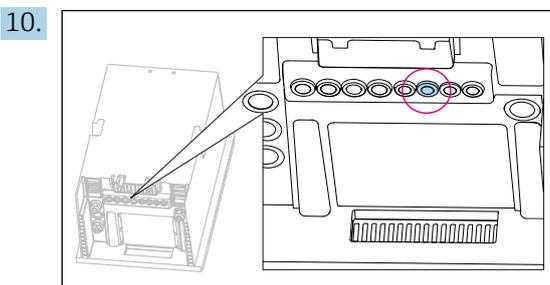
Guidare il cavo del tubo flessibile degli scarti riscaldato attraverso il pressacavo indicato.
