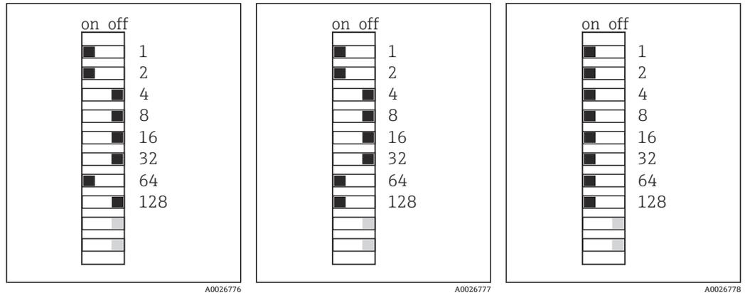
図 51 有効な PROFIBUS アドレス 67      図 52 有効な Modbus アドレス 195      図 53 無効なアドレス 255<sup>1)</sup>
