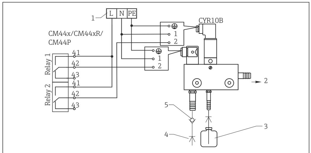
図 44 CYR10 インジェクター洗浄ユニットの接続
