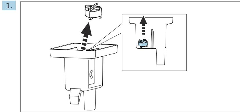
磁気スターバーを測定チャンバから取り外します。
