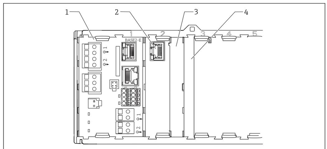
図 28 コントローラハウジングの端子部
