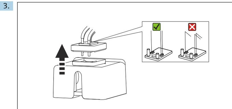
キュベットのゴム製カバーを持ち上げて取り外します。キャピラリーホルダまたはバルブのキャピラリーにねじれがないことを確認します。キャピラリーをホースコネクタから取り外さないでください。
