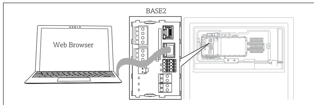
図 54 Web サーバー/Ethernet 接続
