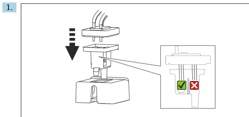
ゴム製カバーをキュベットの元の位置に取り付け、すべてのキャピラリが測定チャンバに配置されていることを確認します。
