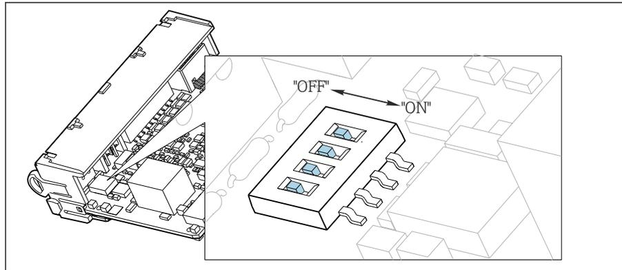
図 49 内部終端処理用の DIP スイッチ
