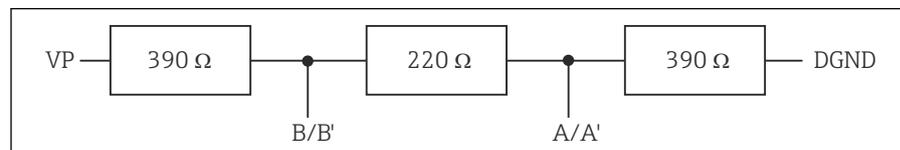
図 50 内部終端の構造
