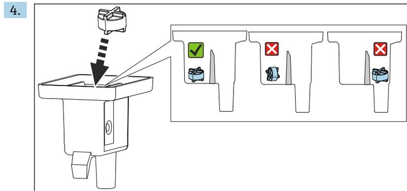
磁気スターバーを測定チャンバに戻し、測定チャンバ内で水平になっていることを確認します。
