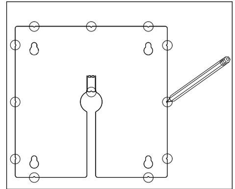
1. 在机柜柜门外侧选择合适的安装板固定位置。选择显示单元的安装位置。
