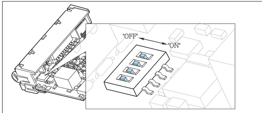
图 40 内部端接的 DIP 开关
