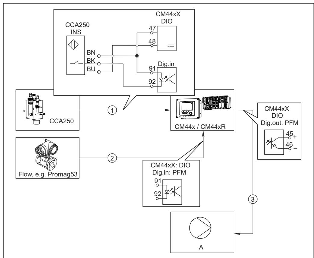
图 51 带前馈控制的余氯控制实例
