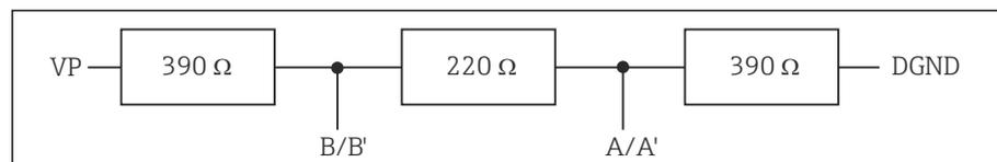
图 41 内部端接示意图
