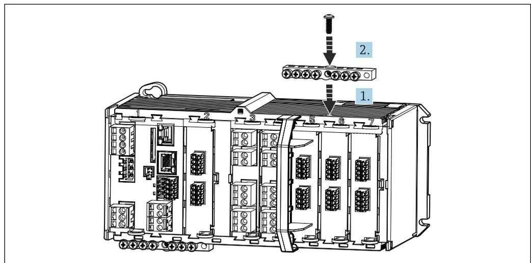
1. 将电缆槽中心孔直接安装在本安 Ex-i 传感器通信模块 2DS 的螺纹螺钉上方。
