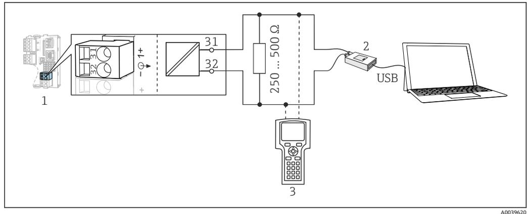
图 12 HART 通信，使用调制解调器
