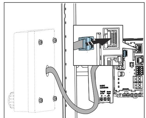
5. 从中间钻孔的位置处拉出显示电缆，通过四个专用钻孔在外侧安装显示单元，确保梅花螺丝仍剩余有半圈未拧紧，但是仍能保证正确的安装位置。确保橡胶条（密封条、蓝色高亮显示）无破损，且固定在柜门表面。
