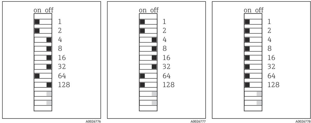
图 42 有效 PROFIBUS 地址 67      图 43 有效 Modbus 地址 195      图 44 无效地址 255 <sup>1)</sup>
