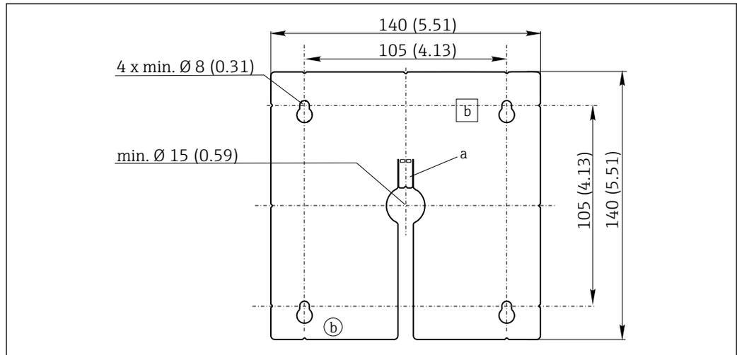
图 10 外接显示单元的安装背板的外形尺寸；单位：mm (in)
