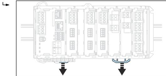
2. 从顶部将设备安装在 DIN 导轨 (a) 上，下压并固定 (b)。
