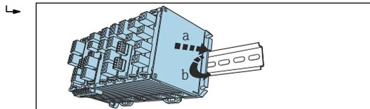
3. 上推固定夹直至啮合到位，将设备固定在 DIN 导轨上。
