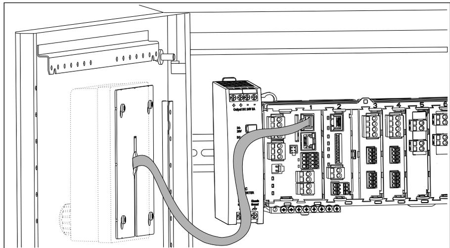
图 11 安装到位的显示单元
