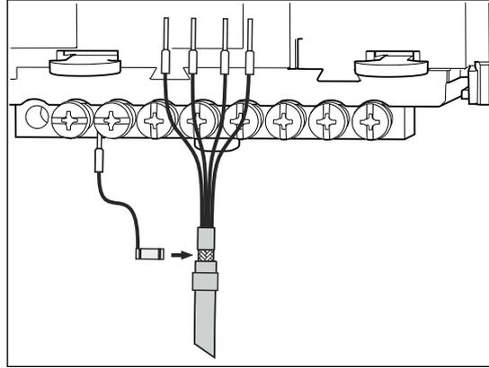
图 17 功能性接地连接示意图
