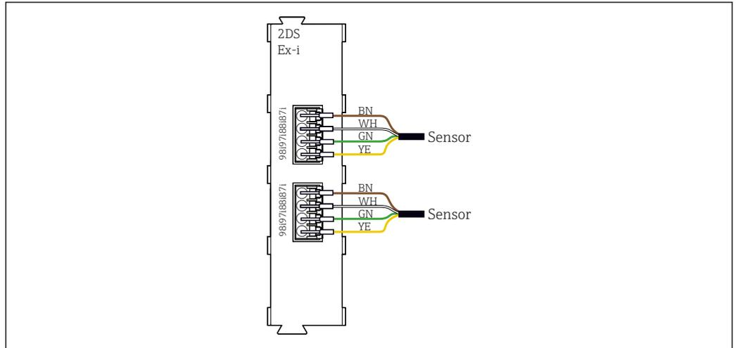
图 21 传感器和本安 Ex-i 型传感器通信模块 2DS，不带附加电源
