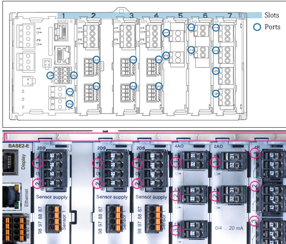
图 3 硬件模块的插槽和端口分配示意图
