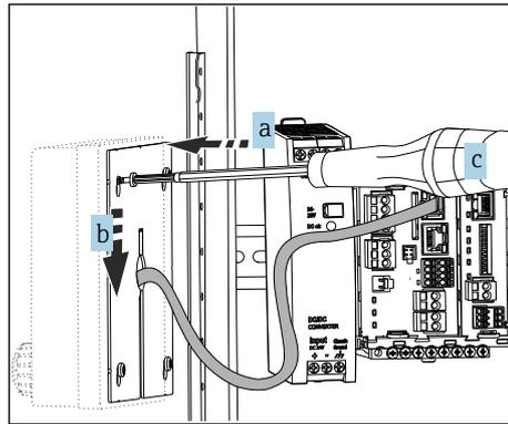
7. 将安装板放置在内侧螺丝 (a) 上，向下滑动螺丝 (b)，并拧紧螺丝 (c)。
