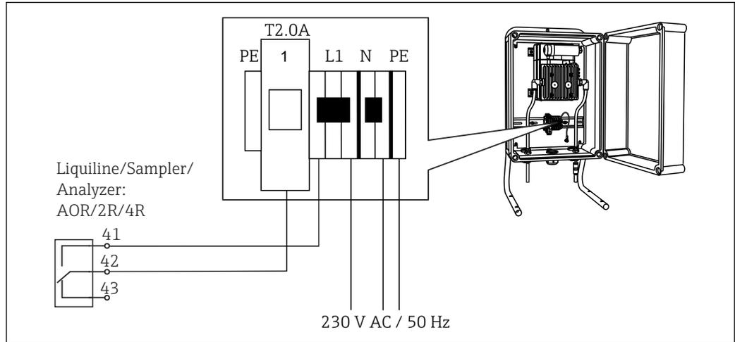
图 34 连接 CAS40D 的清洗单元
