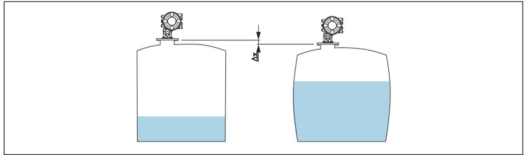
22 Bewegung  $\Delta x$  der Tankreferenzhöhe aufgrund der durch den hydrostatischen Druck verursachten Wölbung der Tankwand
