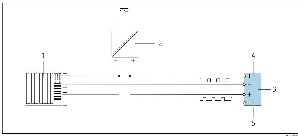
**Fig. 17 Exemplo de conexão para saída de pulso duplo (passiva)**
