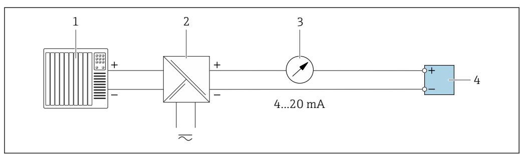
■ 13 Exemplo de conexão para saída de corrente 4-20 mA (passiva)
