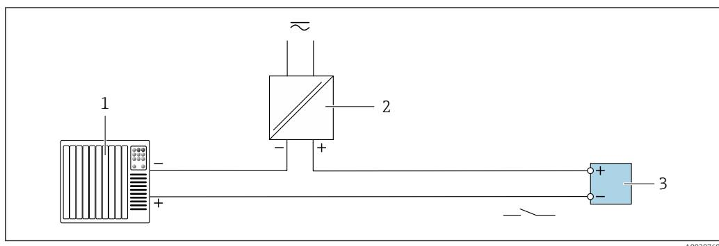
**Fig. 18 Exemplo de conexão para saída a relé (passiva)**
