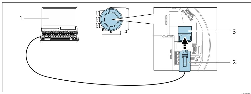
26 Conexão através de Interface de operação (CDI-RJ45)
