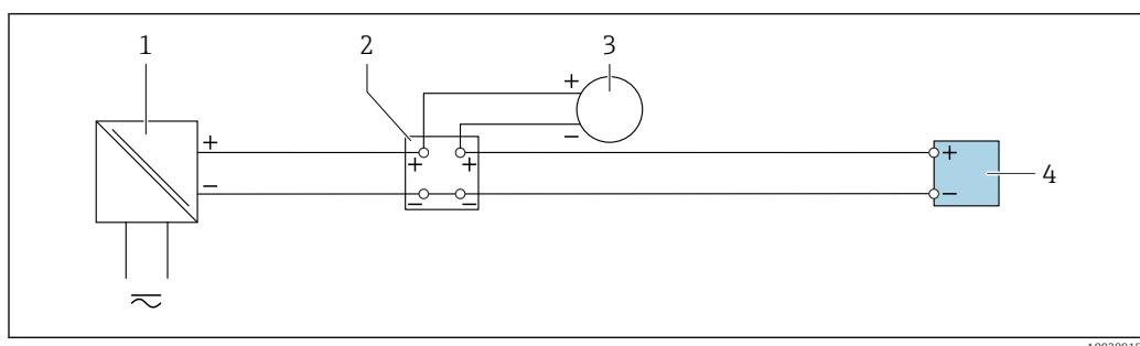
**Fig. 19 Exemplo de conexão para entrada em corrente de 4 a 20 mA**
