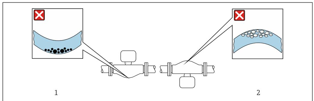
☒ 6 Orientación del sensor con tubo de medición curvado
