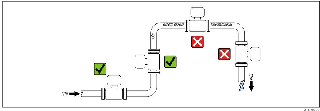
Para evitar que la acumulación de burbujas de gas en la tubería de medición provoque errores de medición, evite los siguientes lugares de montaje en las tuberías:
