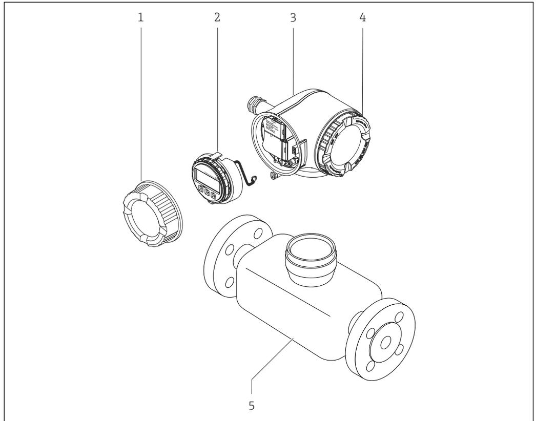
1 Componentes importantes del instrumento de medición
