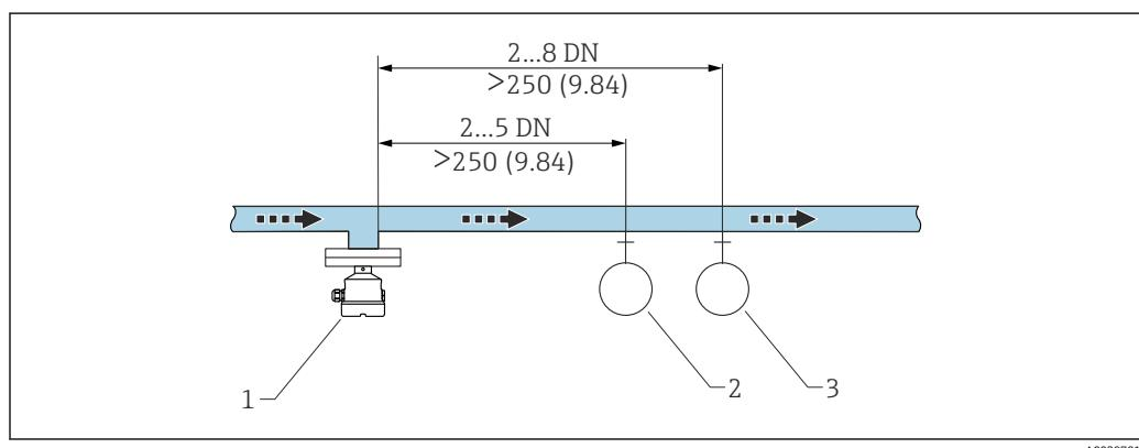
图 23 后直管段的安装。测量单位 mm (in)
