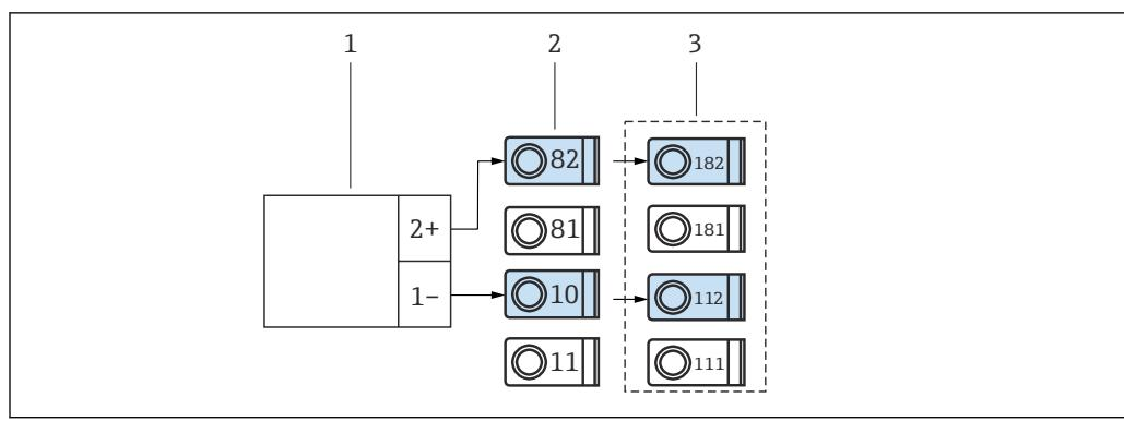
图 10 密度传感器连接图，带脉冲输出
