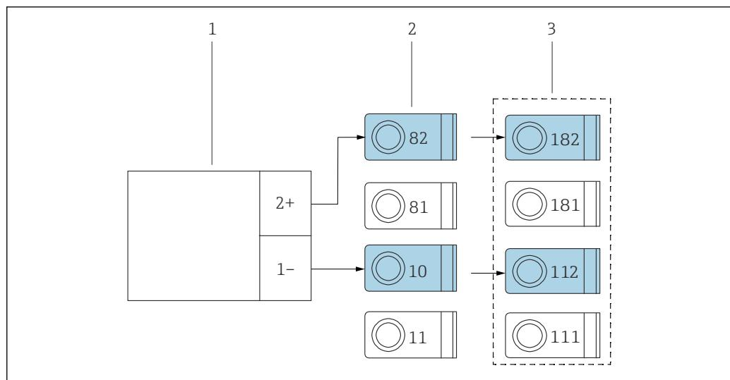
图 12 压力传感器连接图，带无源电流输出
