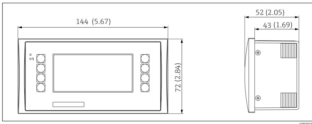
图 37 盘装型仪表的操作与显示单元。测量单位 mm (in)
