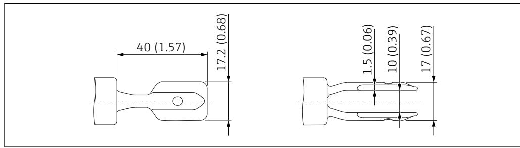
图 32 音叉, 带塑料涂层。测量单位 mm (in)
