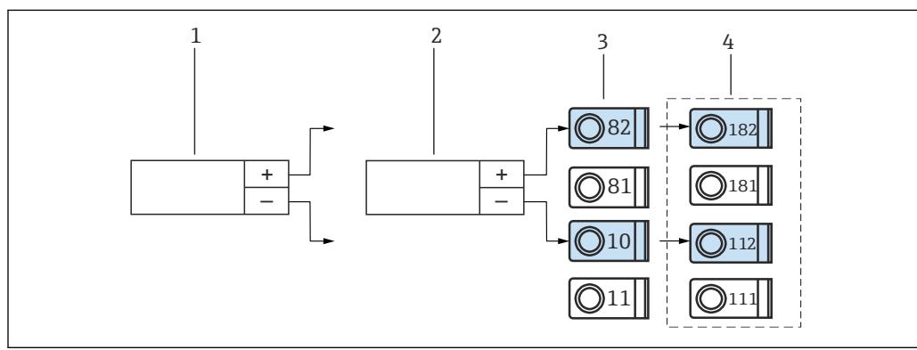
图 11 温度传感器连接图，通过模块化温度变送器连接
