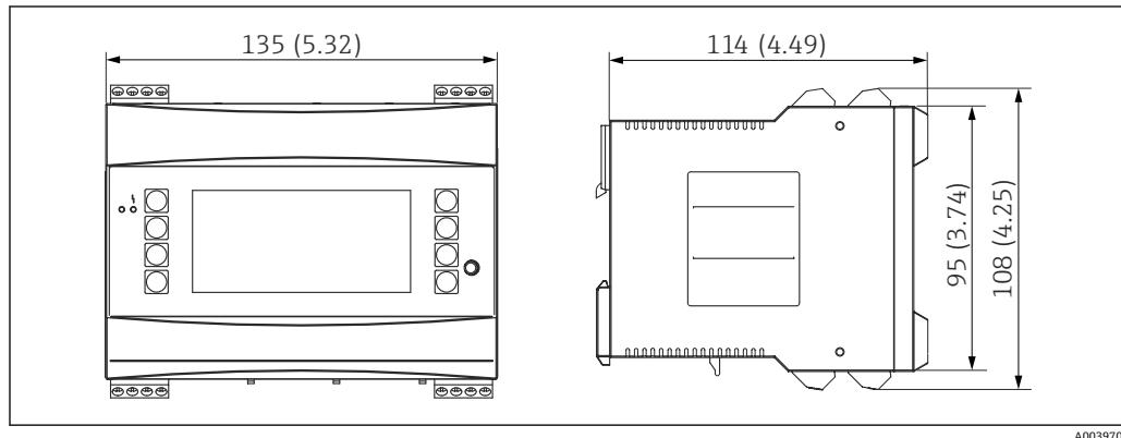
图 35 安装在符合 IEC 60715 标准的 DIN 导轨上的外壳。测量单位 mm (in)
