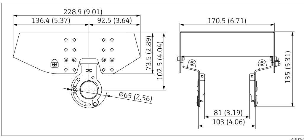
图 39 防护罩, 适用双腔室铝外壳。测量单位 mm (in)
