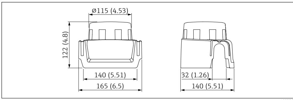
图 40 防护罩, 适用单腔室铝外壳或铸造 316L 外壳。测量单位 mm (in)
