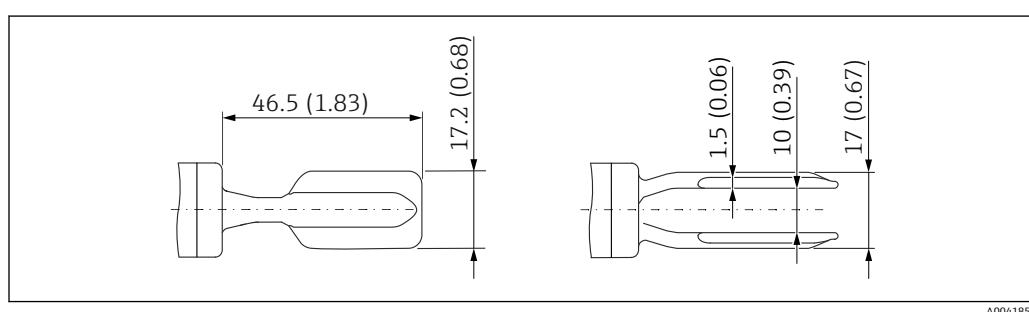
图 33 音叉, 带搪瓷涂层。测量单位 mm (in)
