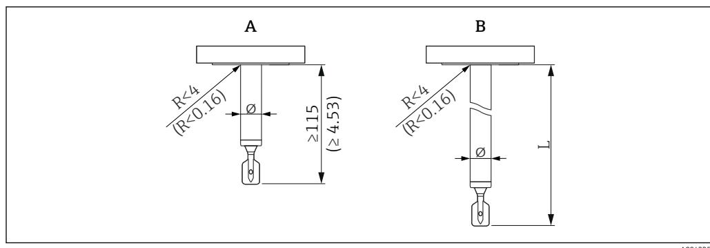
图 31 探头类型: 短管型, 延长管型。测量单位 mm (in)
