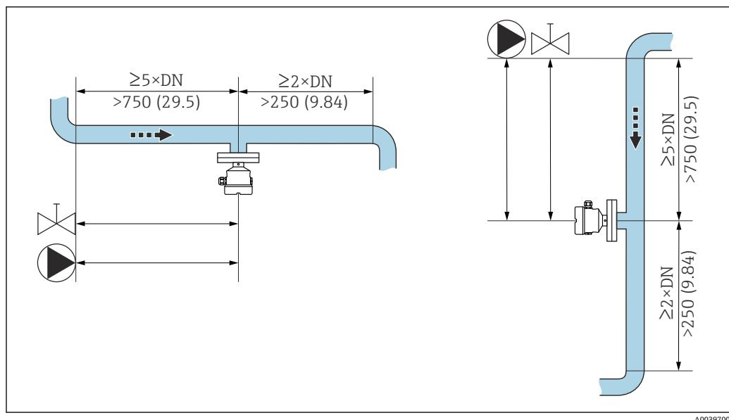
图 22 前直管段的安装。测量单位 mm (in)
