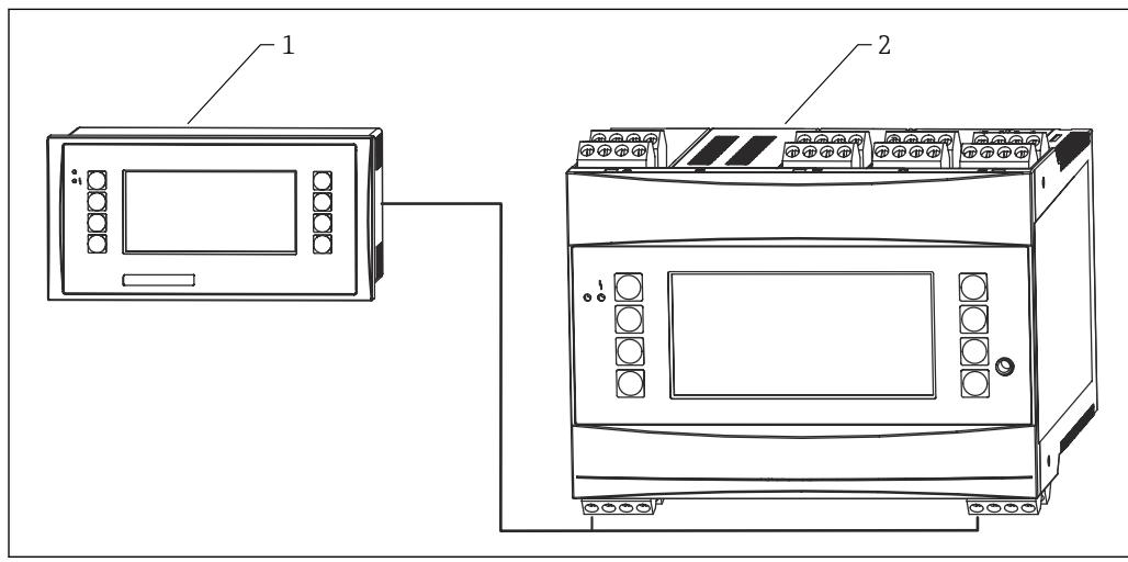
图 38 安装在盘装型外壳内的操作与显示单元
