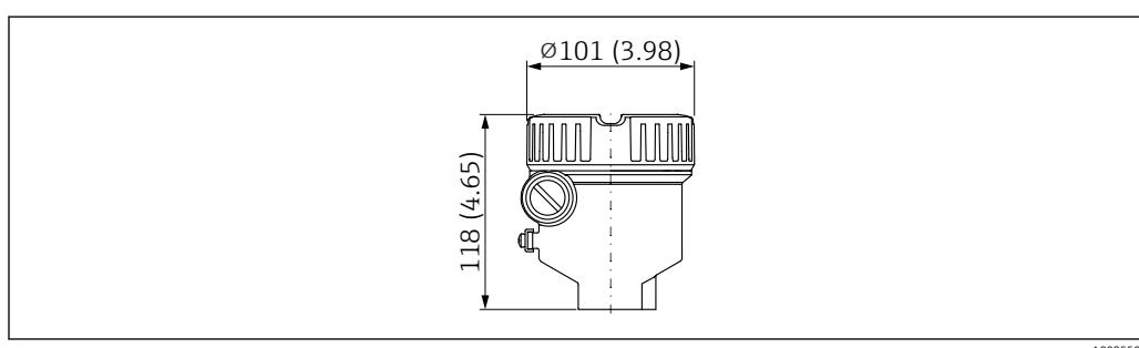
图 29 单腔体; 316L, 铸造; 通过 Ex d/XP 防爆认证。测量单位 mm (in)
