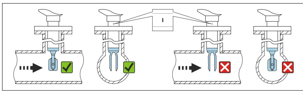
图 24 安装在管道中 (注意叉体安装位置和标记)
