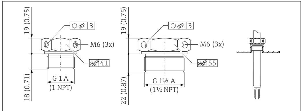
图 51 常压滑动套管  $p_e = 0 \text{ bar}$  (0 psi)。测量单位 mm (in)
