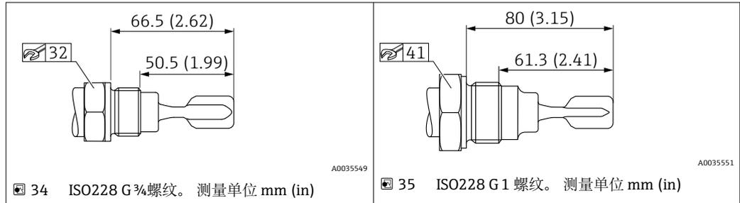
**ISO228 G 螺纹，带平面密封圈**
