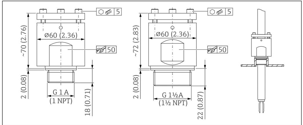
图 52 高压滑动套管。测量单位 mm (in)
