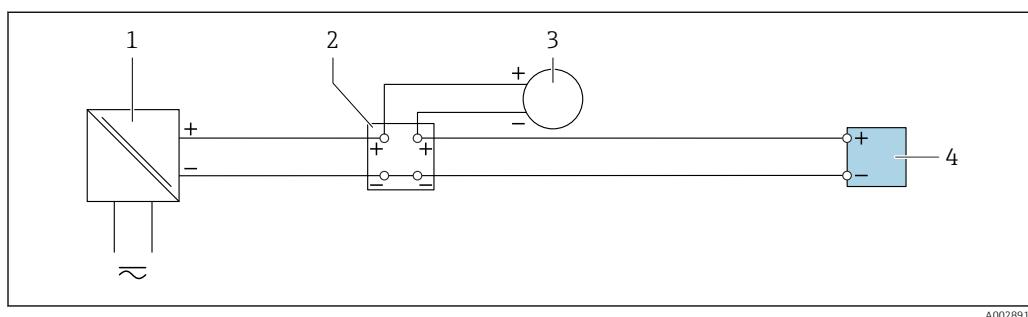
■ 19 Пример подключения для токового входа 4-20 мА
