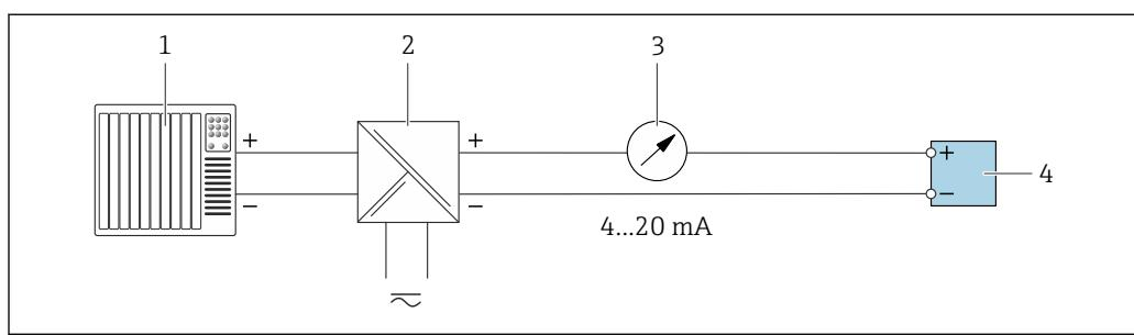
■ 13 Пример подключения для токового выхода 4–20 мА (пассивного)
