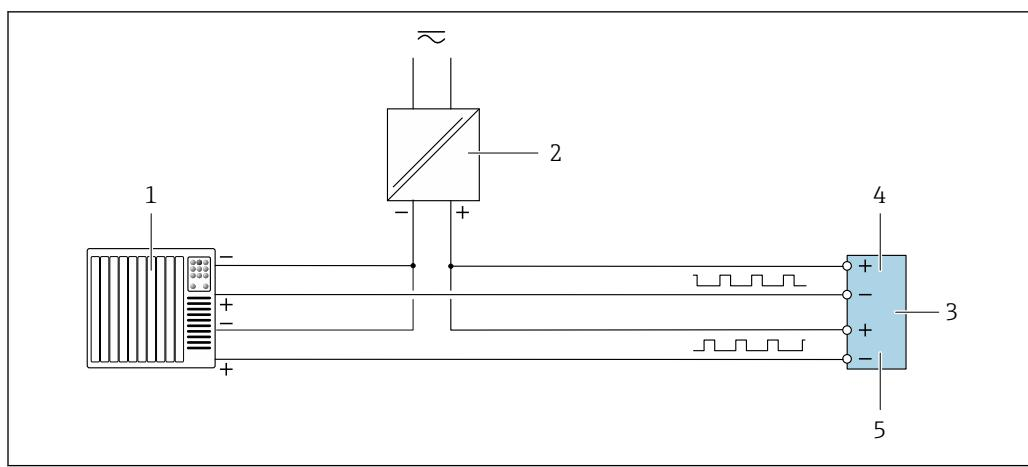
■ 17 Пример подключения двойного импульсного выхода (пассивного)
