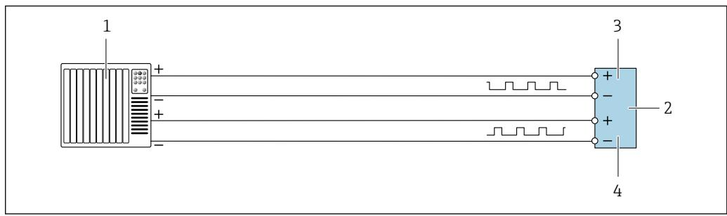
■ 16 Пример подключения двойного импульсного выхода (активного)
