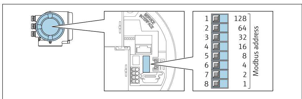
Установите требуемый адрес прибора с помощью DIP-переключателей в клеммном отсеке.
