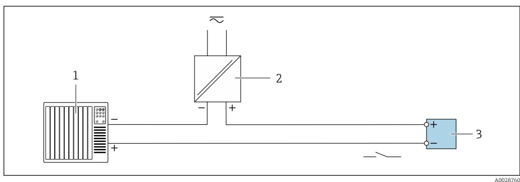
■ 15 Пример подключения для релейного выхода (пассивного)
