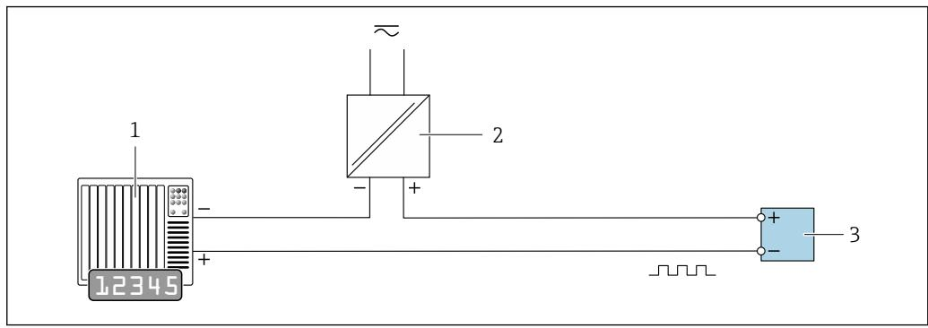
■ 14 Пример подключения для импульсного/частотного выхода (пассивного)
