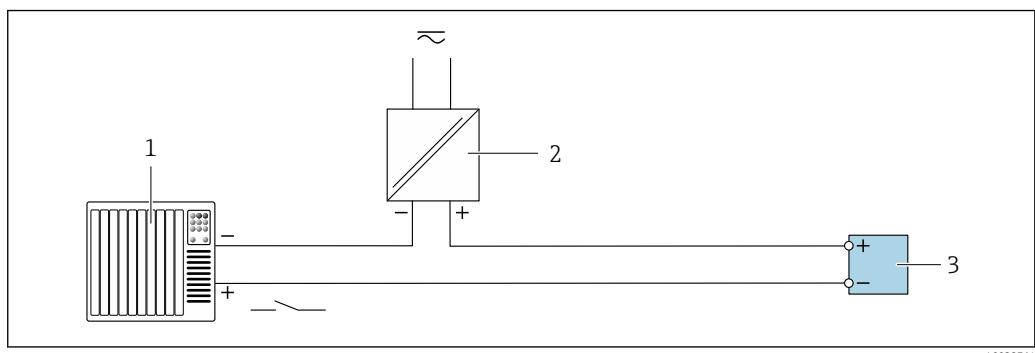
■ 20 Пример подключения для входного сигнала состояния
