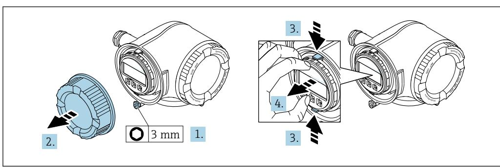
1. Ослабьте фиксирующий зажим крышки клеммного отсека.
