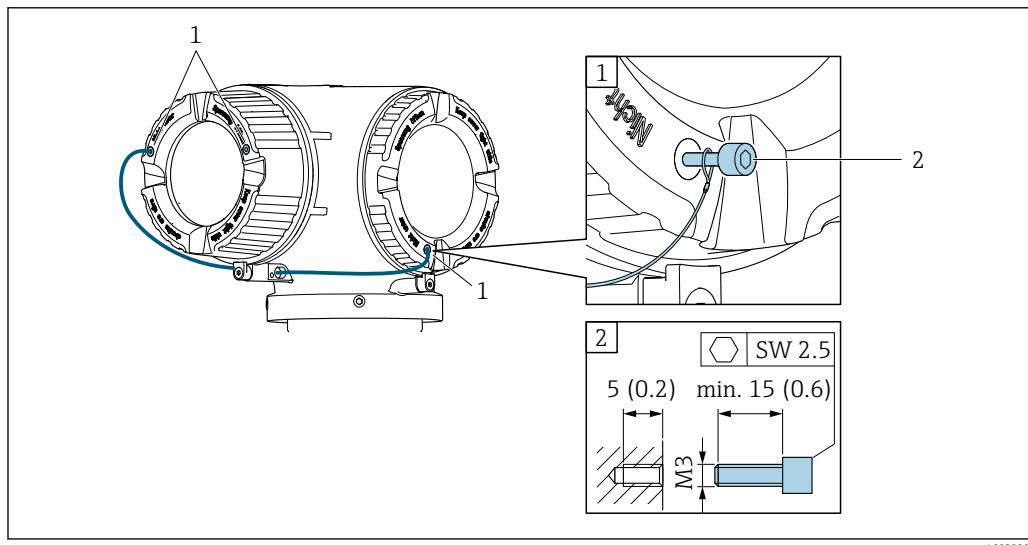
1 Отверстие в крышке для фиксирующего винта
