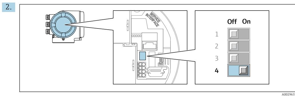
Для перехода от программной адресации к аппаратной переведите DIP-переключатель в положение **On**.
