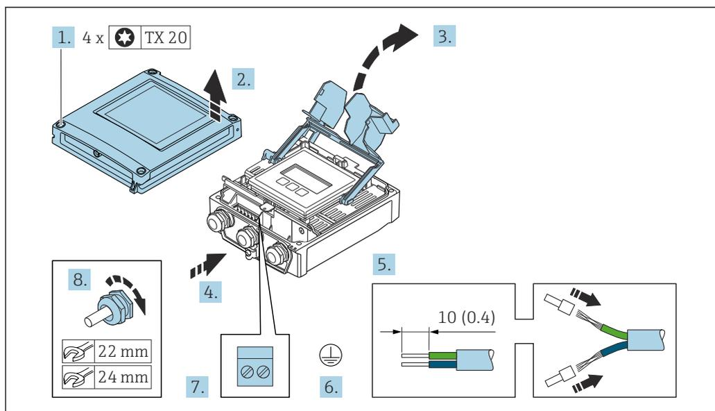
1. Ослабьте 4 фиксирующих винта на крышке корпуса.
