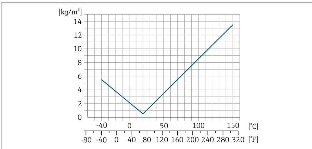
47 Калибровка по плотности на месте эксплуатации, в примере - при температуре +20 °C (+68 °F)
