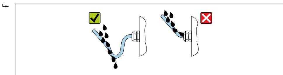
6. Вставьте заглушки (соответствующие степени защиты, которая обеспечивается корпусом) в неиспользуемые кабельные вводы.
