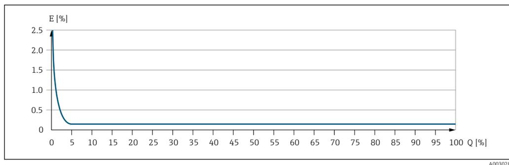
$E$  Максимальная погрешность измерения в % ИЗМ (пример)
