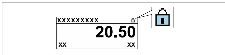
2. При переводе переключателя защиты от записи (WP) на главном модуле электроники в положение **OFF** (заводская настройка) аппаратная защита от записи деактивируется.
