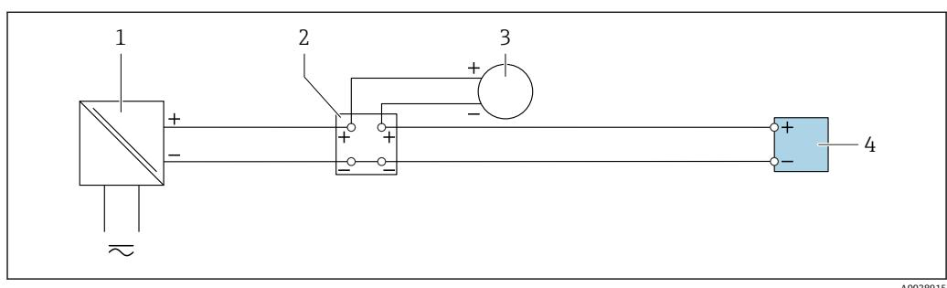
図 26 4~20 mA 電流入力の接続例
