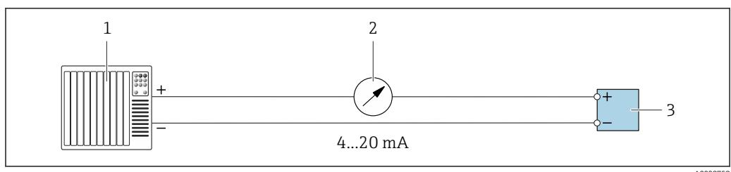
図 19 4~20 mA 電流出力（アクティブ）の接続例
