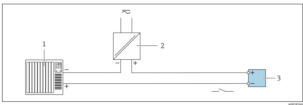
図 25 リレー出力（パッシブ）の接続例
