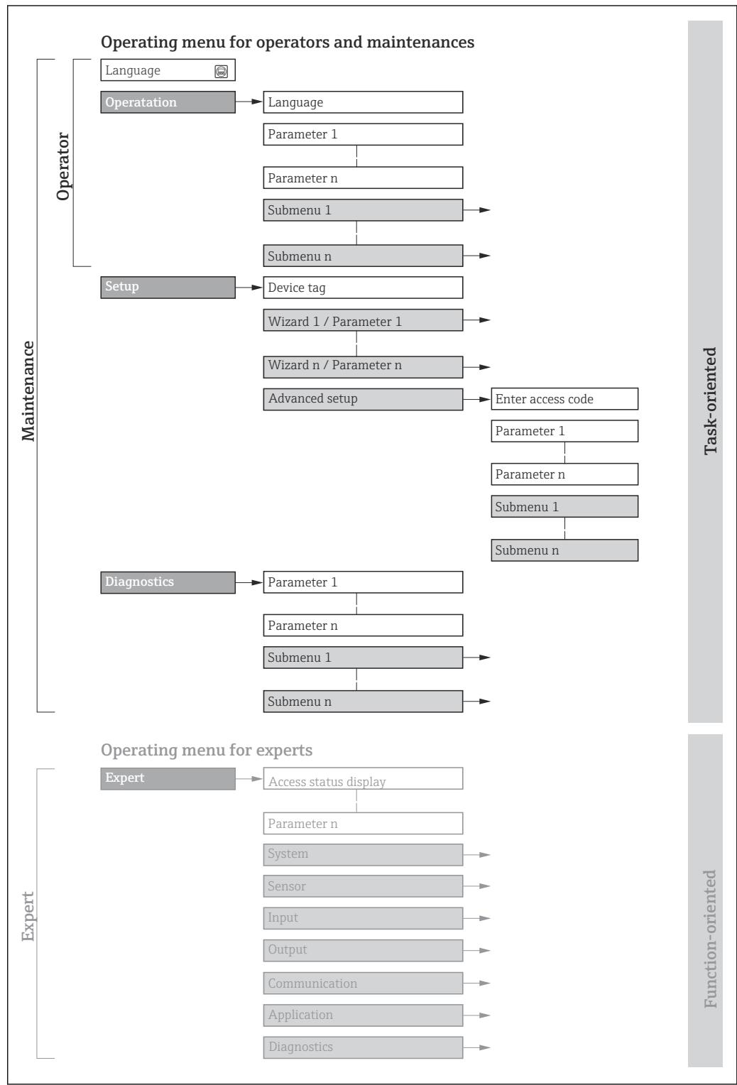
図 28 操作メニューの概要構成
