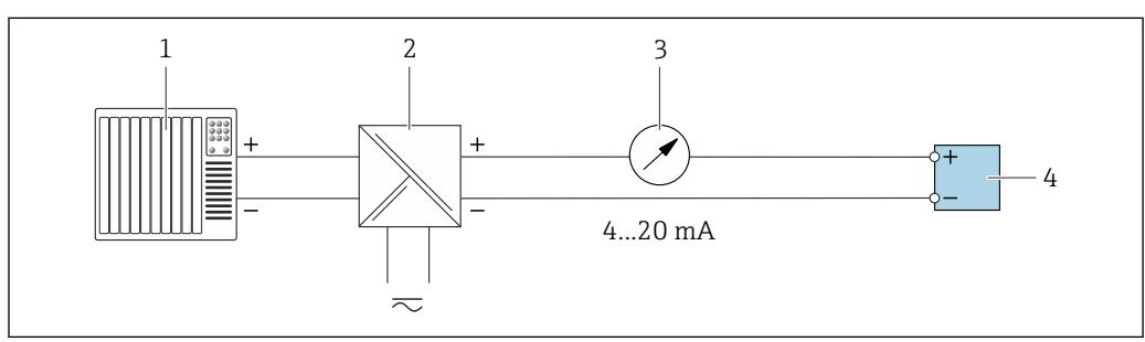
図 20 4~20 mA 電流出力（パッシブ）の接続例
