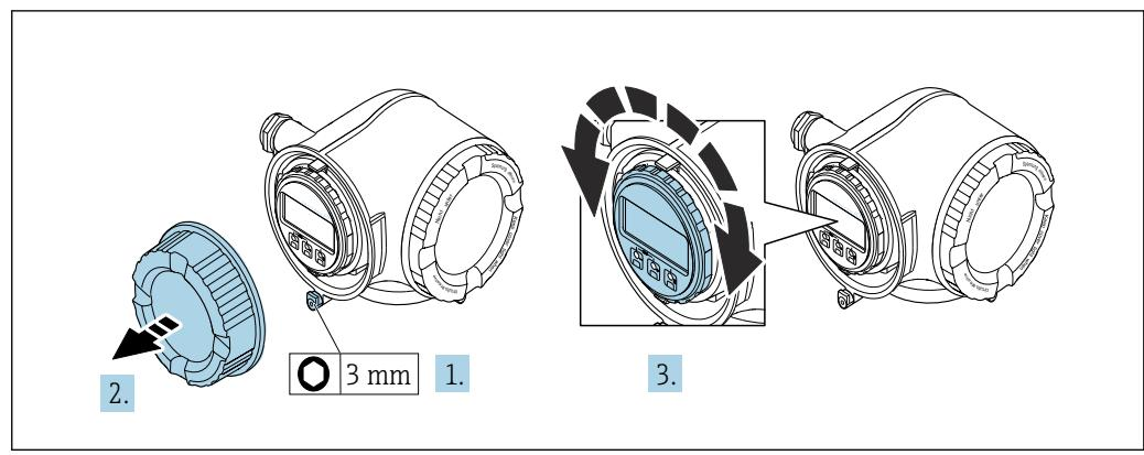
1. 機器バージョンに応じて、端子部カバーの固定クランプを緩めます。
