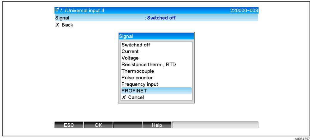
5 PROFINET als Eingangssignal konfigurieren
