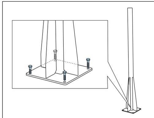
Erga o poste e instale-o com segurança na fundação usando 4 parafusos de fixação (a serem providenciados pelo cliente. <sup>1)</sup>).
