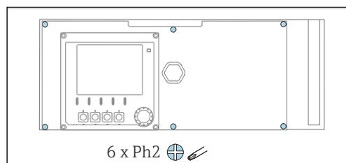
Solte os 6 parafusos na tampa do compartimento de componentes eletrônicos usando uma chave Phillips e dobre a tampa para a frente.
