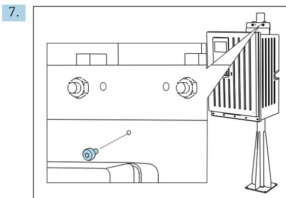
Fixe a unidade de suporte de parede no lugar com o parafuso providenciado.
