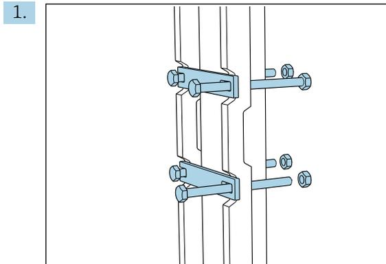
Encaixe a braçadeira do retentor em poste nas hastes de retenção e no poste usando as porcas.
