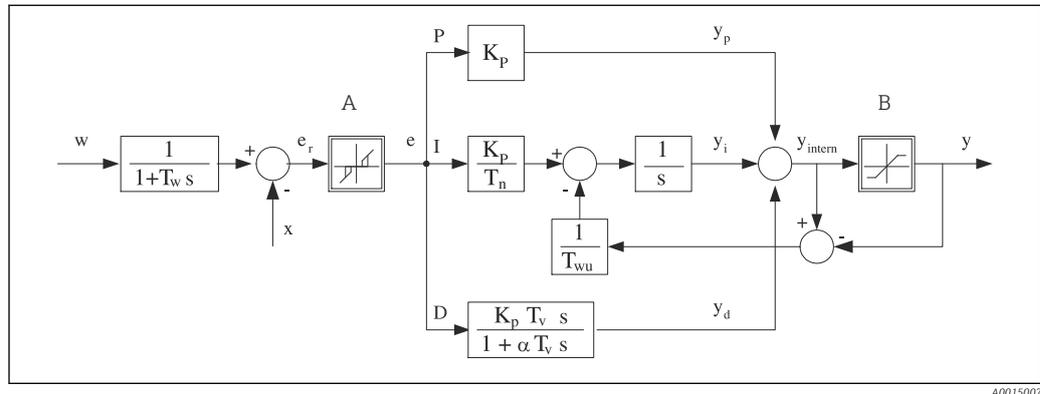
77 Diagrama em blocos da estrutura do controlador
