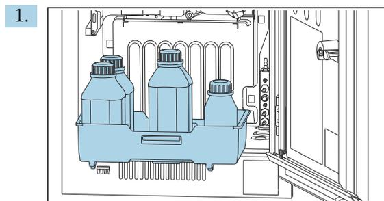
Remova a bandeja da garrafa: Eleve o cabo encaixado levemente e empurre-o para a frente.
