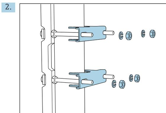
Encaixe as contraporcas e aperte o retentor em poste usando arruelas de pressão e porcas.
