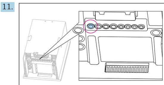
Guie o cabo da fonte de alimentação, o qual é providenciado pelo cliente no local da instalação, através do prensa-cabos indicado.
