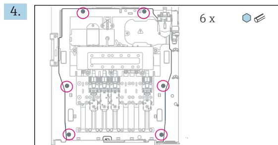
Solte os 6 parafusos da placa portadora usando uma chave Allen.
