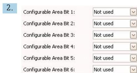
In der Werkseinstellung haben alle Bits in der Spalte der **Configurable Area Bits** den Wert **not used** (nicht benutzt).
