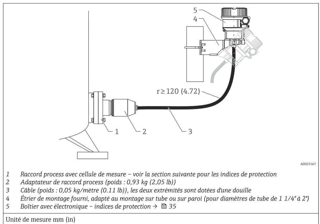
Indices de protection pour le raccord process et la cellule de mesure en utilisant
