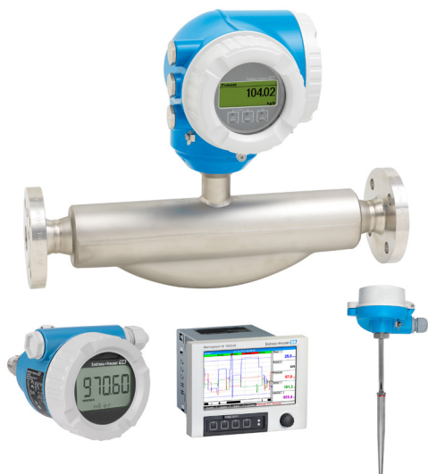
Instruments de mesure employée : Proline Promass F 300 (photo du haut, point de mesure F dans le graphique), Cerabar PMP51B (photo en bas à gauche, point de mesure P dans le graphique), thermorésistance TR15 (photo en bas à droite, point de mesure T dans le graphique) ainsi que Memograph M RSG45 (photo centrale en bas, graphique « Enregistrement des données »)
